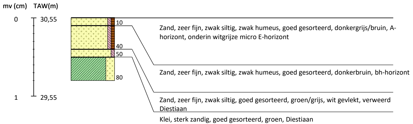
Boring 6 Lb 72-coördinaten: 206244/196849
