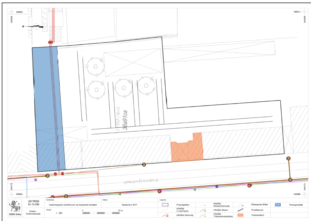
Afb. 28: Sleuvenplan met aanduiding van het onderzoeksgebied (zwart), de elektriciteitsleidingen op het terrein (blauw) en de kelderzone (bruin) (Bron: Aron bvba, digitaal plan, dd 19/09/2017, aanmaakschaal 1:300, 2017I208).
