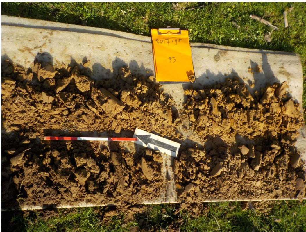
Afb. 34. Het humeuze bodemprofiel van boring 33 (uitgelegd van links naar rechts: 0-50 cm, 50 – 100 cm, boven: 100-150cm, 150-200 cm -mv.).
