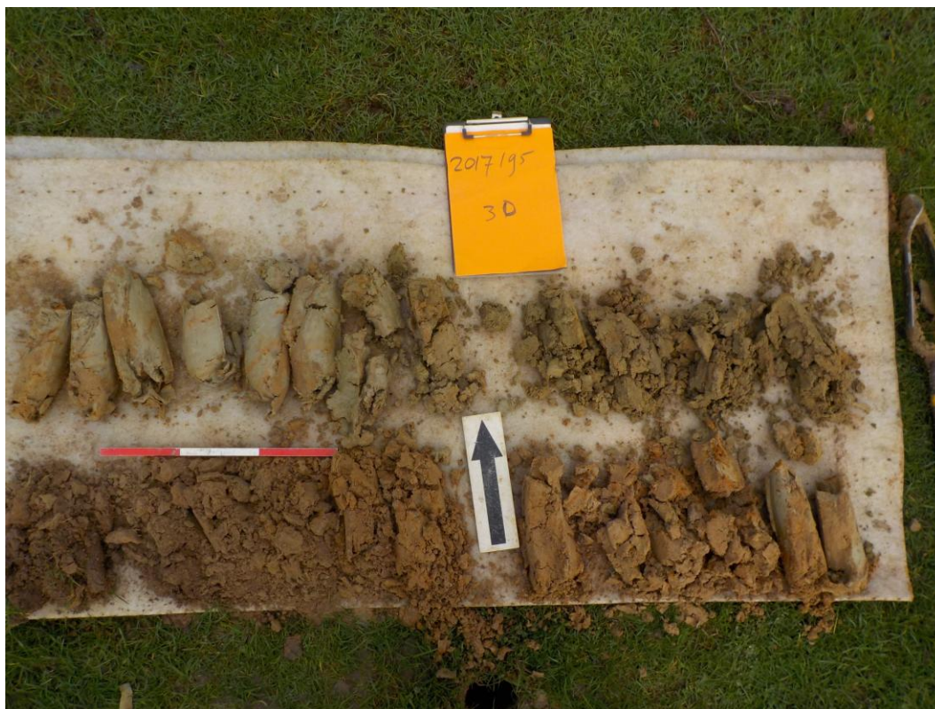
Afb. 32. Boring 30 (uitgelegd van onder naar boven en van links naar rechts: 0-50 cm, 50 – 100 cm, boven: 100 -150cm, 150 – 200 cm -mv).
