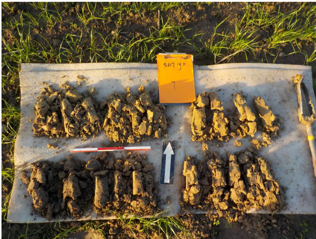
Afb. 33. Boring 7 (uitgelegd van onder naar boven en van links naar rechts: 0-50 cm, 50 – 100 cm, boven: 100-150cm, 150 – 200 cm -mv.).
