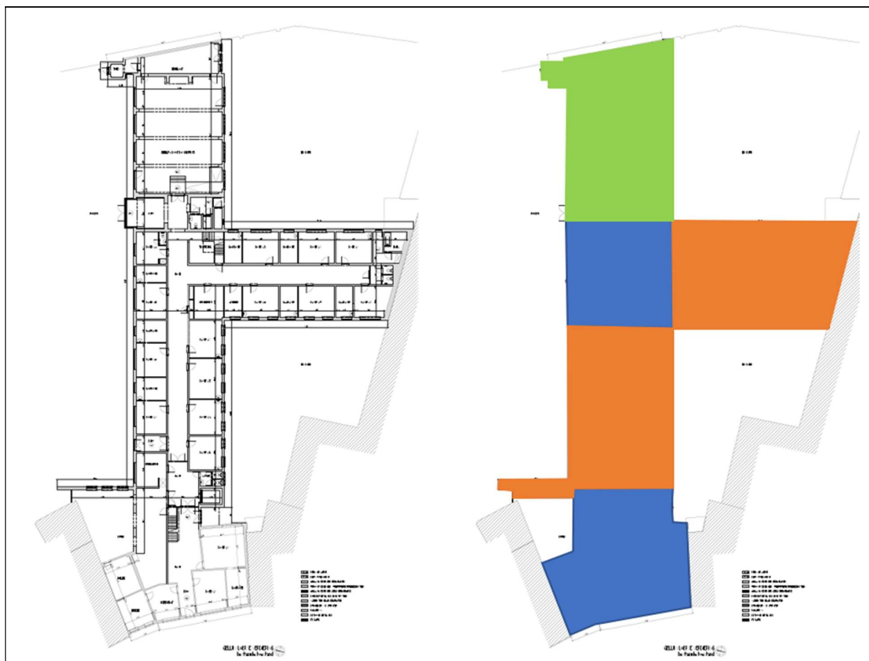
Figuur 4. Overzicht van de dieptes van de funderingen van het rusthuis: blauw=fundering tot -2,7 m; oranje=fundering tot -1,2 m; groen=fundering tot -80 cm.
