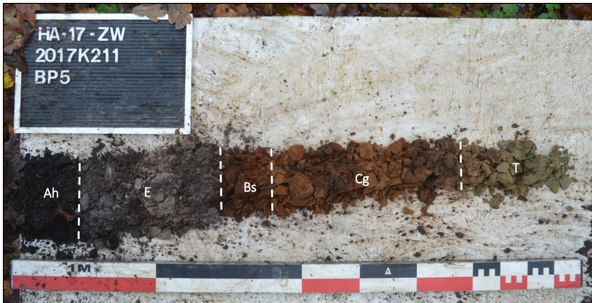
Afb. 32: Referentieprofiel BP5 met horizonen Ap – E – Bs – C – T (Bron: ARON bvba, dd. 29/11/2017, 2017K211).
