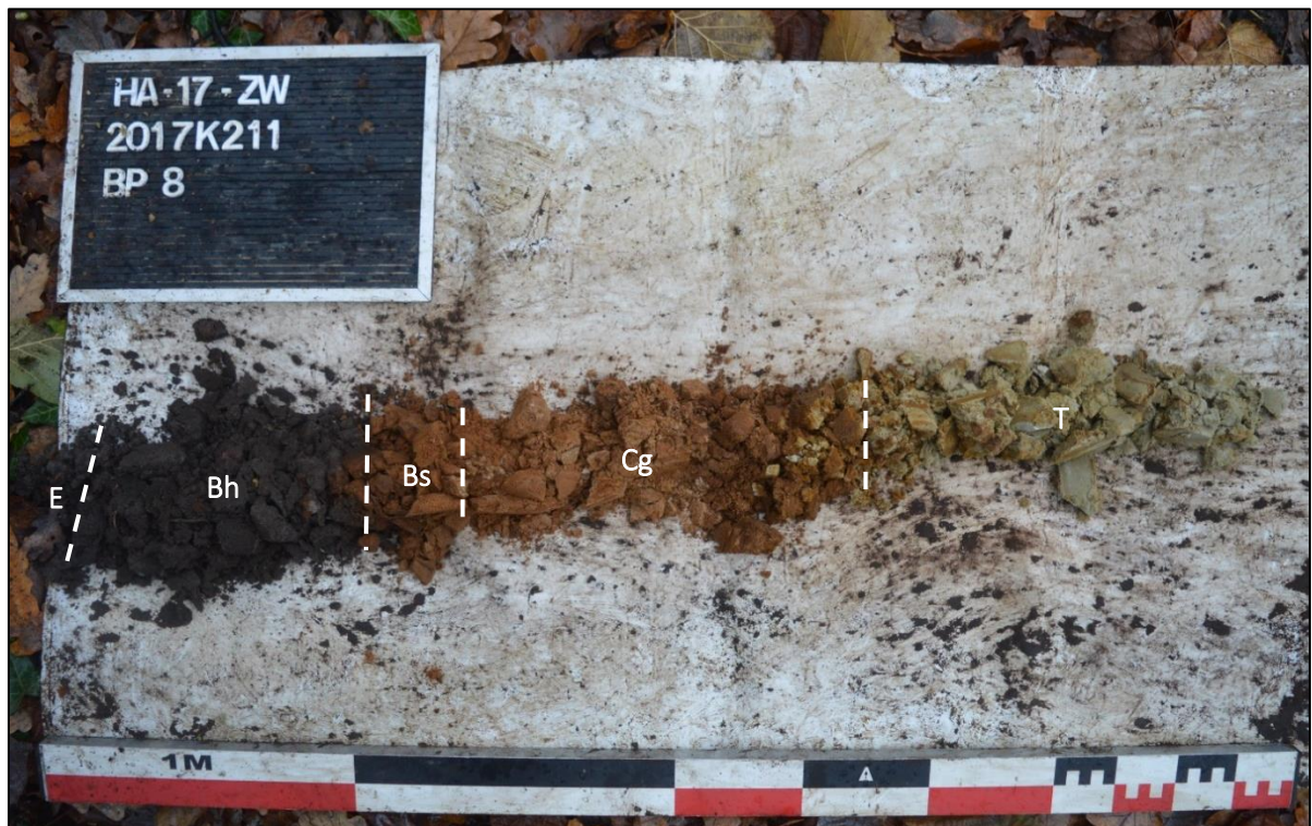
Afb. 31: Referentieprofiel BP 8 met horizonten E – Bh – Bs – C – T (Bron: ARON bvba, dd. 29/11/2017, 2017K211).
