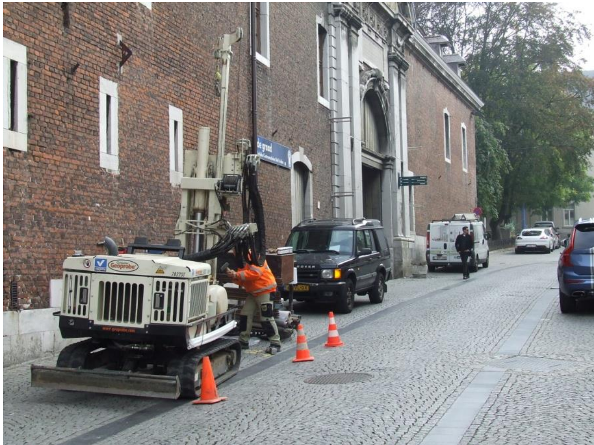
figuur 45 Uitvoeren van boring 1 met behulp van de Geoprobe, Boorstelling in de Diesterstraat (foto R. Paulussen).
