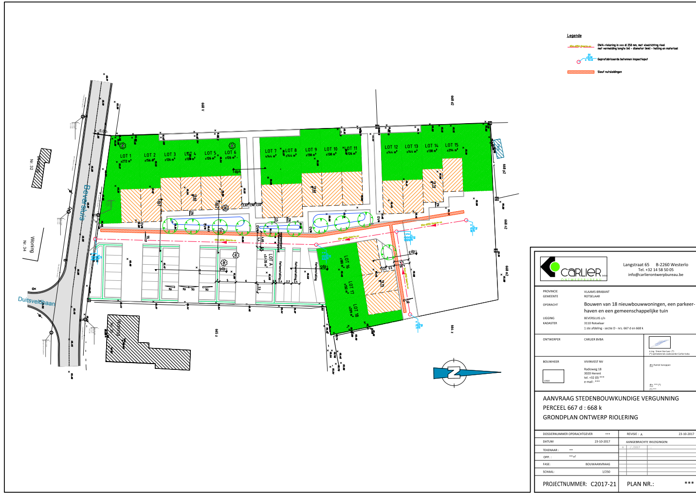
Fig. 1.6: Grondplan ontworpen toestand – riolering (bron: Carlier bvba).
