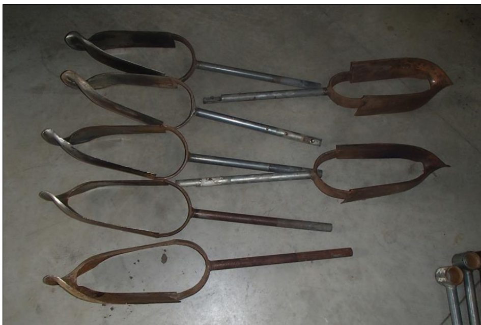
Figuur 3: Voorbeeld Edelmanboor met grotere diameter (in dit geval 15 cm) (©BAAC)
