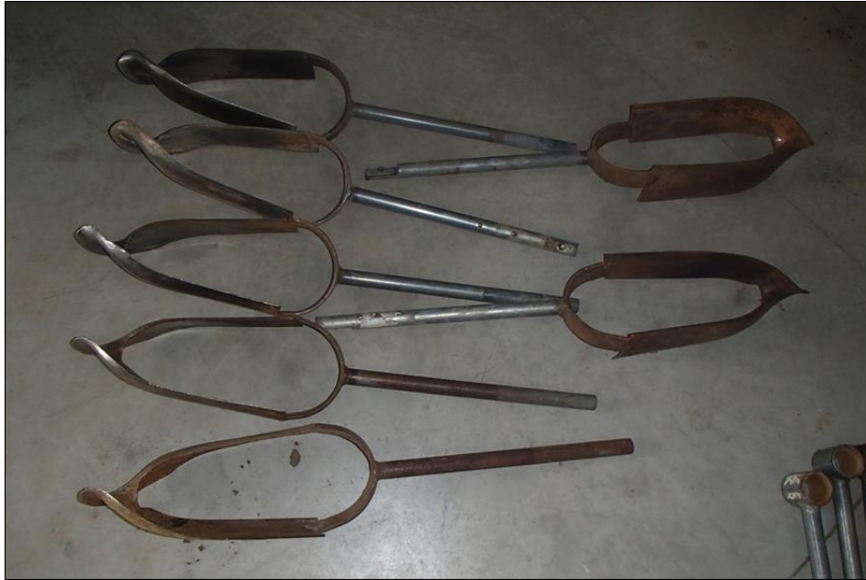
Figuur 8: Voorbeeld Edelmanboor met diameter van 15 cm (©BAAC)
