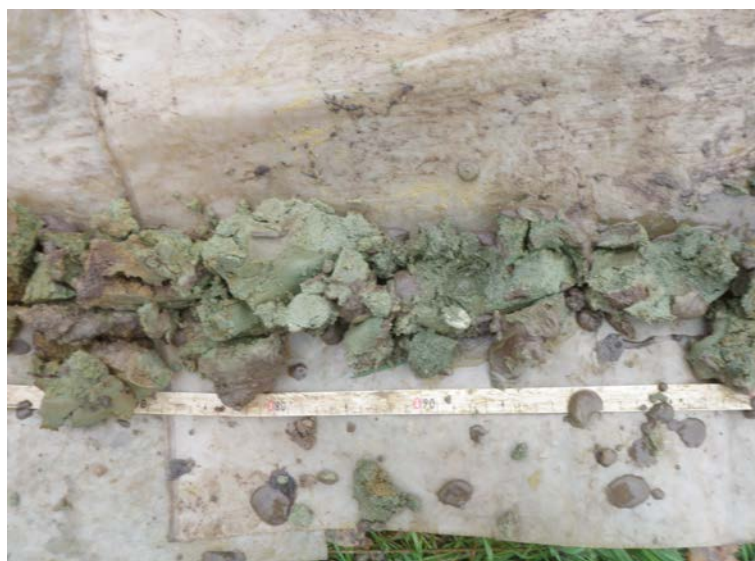
Fig. 2.3. Boringen - Ulfortstraat (23.017). Detail van boring 3: laag van zwak grindig, matig grof zand op 90 cm onder maaiveld.
