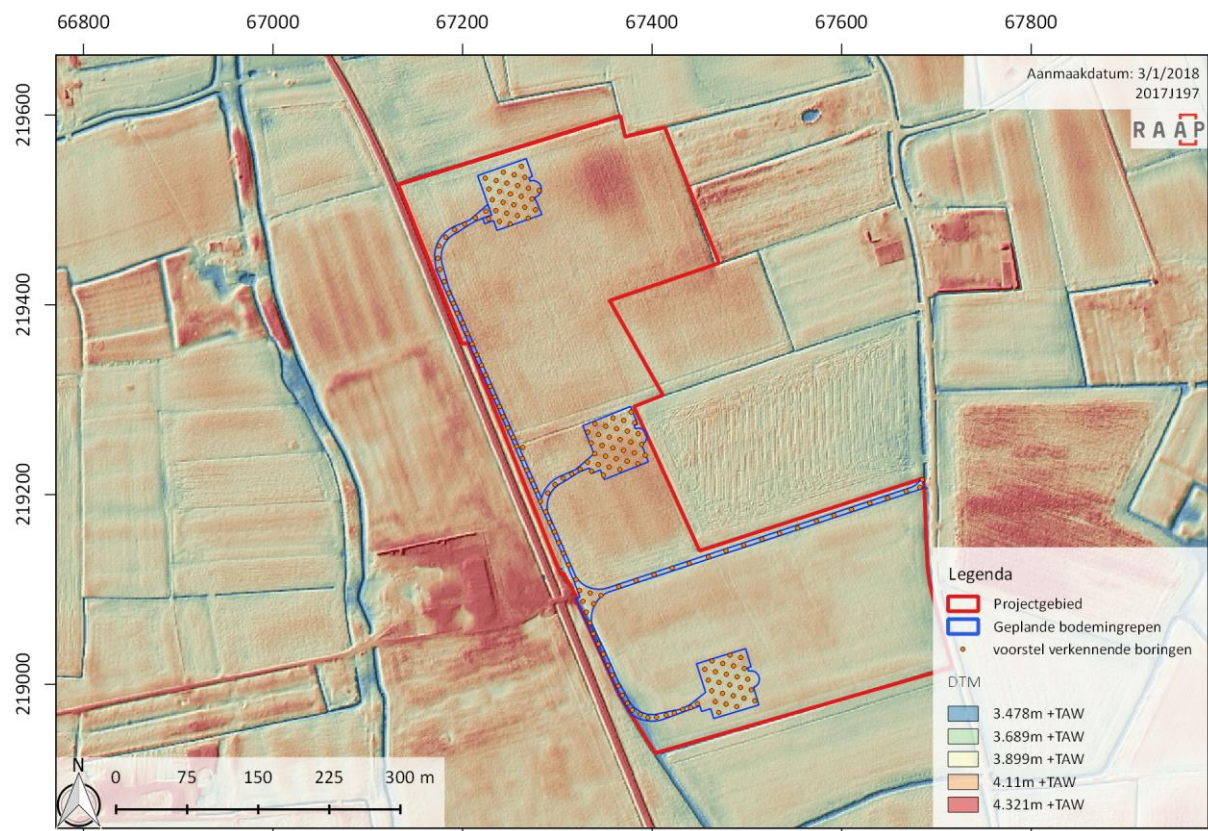
Figuur 5: Boorplan voor verkennende archeologische boringen geprojecteerd op het digitaal hoogtemodel (schaal 1:8000; bron: AGIV)
