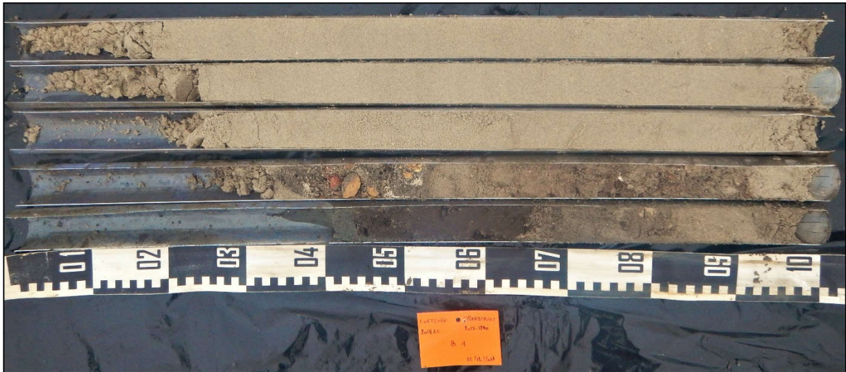
Figuur 44: Boring 1, van 0 cm (linksonder) tot 500 cm (rechtsboven).
