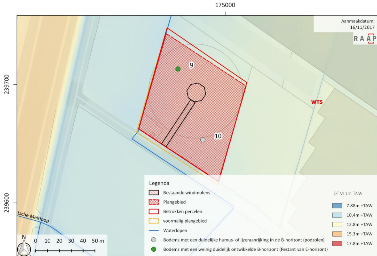
Figuur 28: Overzicht van de inplanting en de interpretatie van de landschappelijke boringen binnen plangebied WT5
