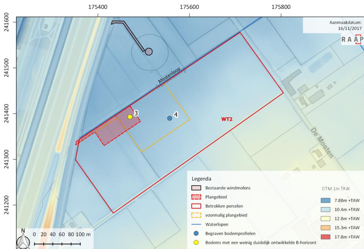
Figuur 25: Overzicht van de inplanting en de interpretatie van de landschappelijke boringen binnen plangebied WT2
