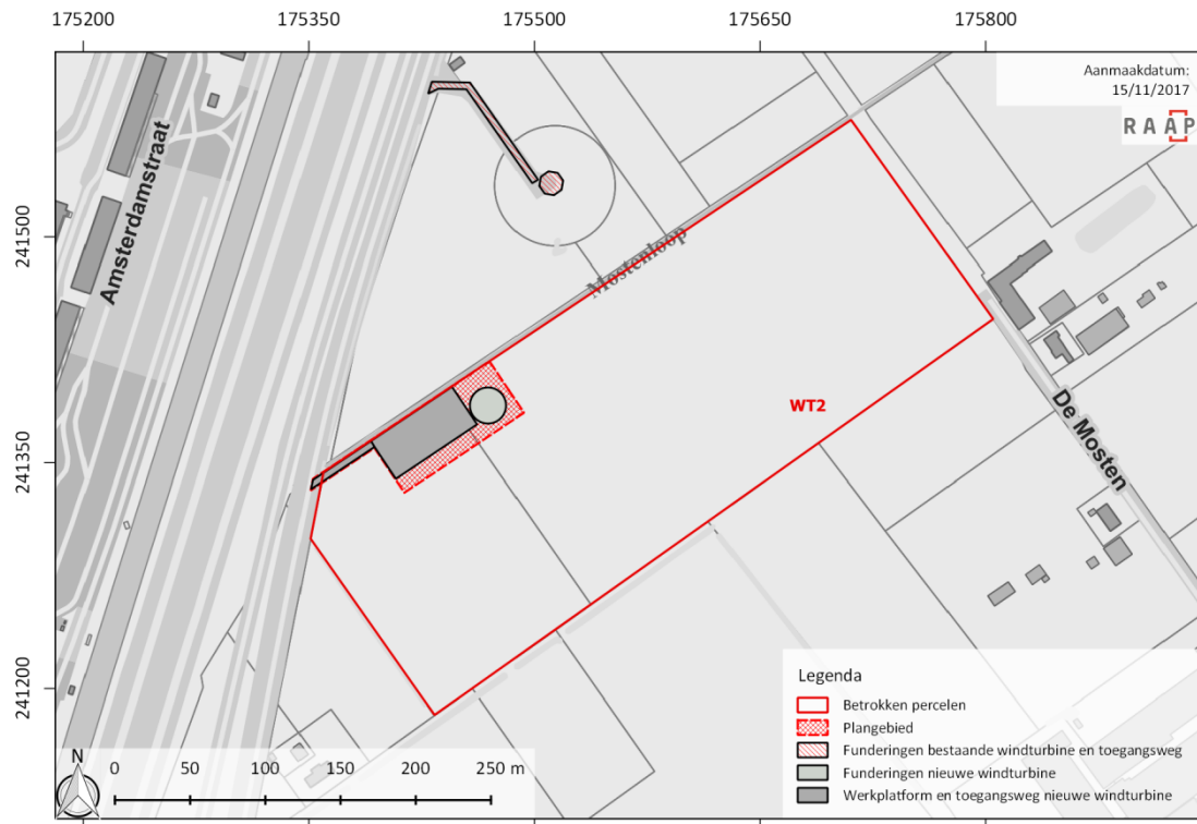
Figuur 12: Situering van WT2 met aanduiding van de bestaande windturbine (rood gearceerd) en de geplande ingreep (fundering van de windturbine (lichtgrijs) en de fundering voor het werkplatform en de toegangsweg (donkergrijs). (schaal 1/3000). (bron: AGIV, 2017b)
