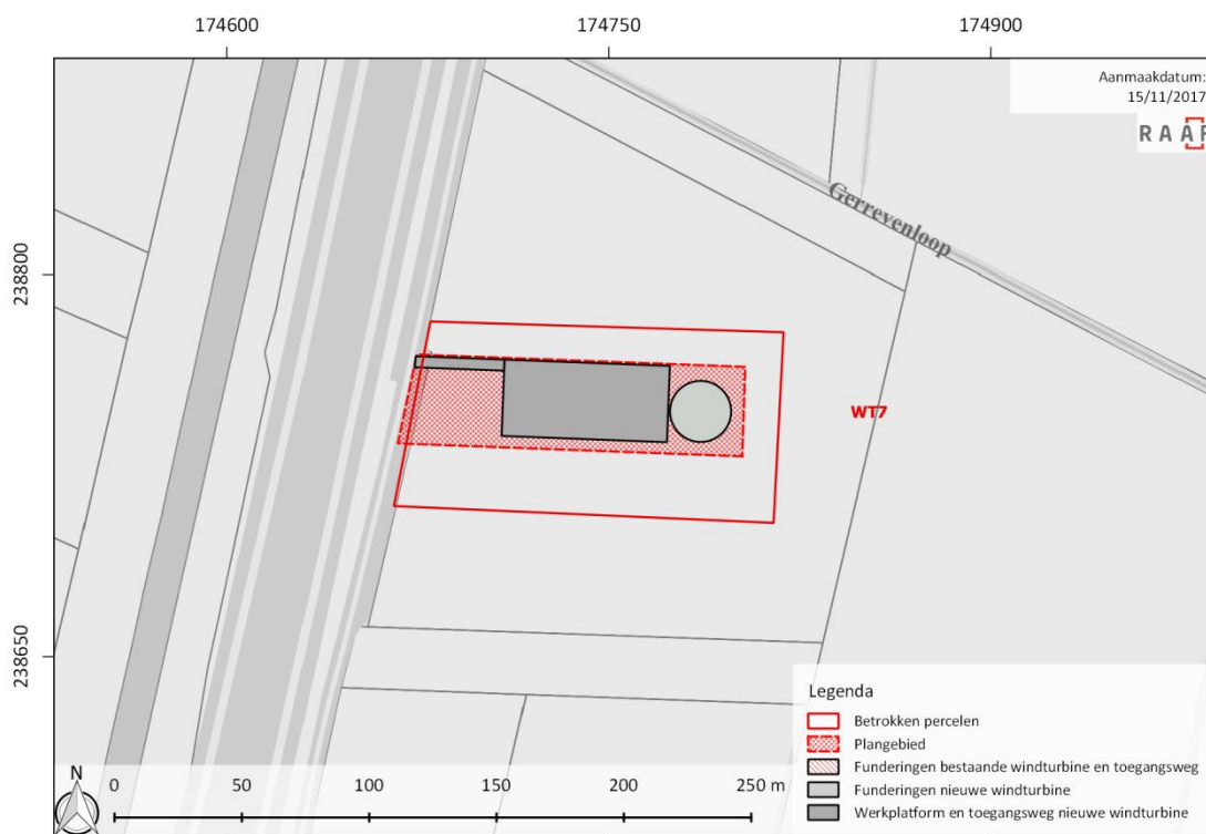
Figuur 17: Situering van WT7 met aanduiding van de bestaande windturbine (rood gearceerd) en de geplande ingreep (fundering van de windturbine (lichtgrijs) en de fundering voor het werkplatform en de toegangsweg (donkergrijs). (schaal 1/3000). (bron: AGIV, 2017b)
