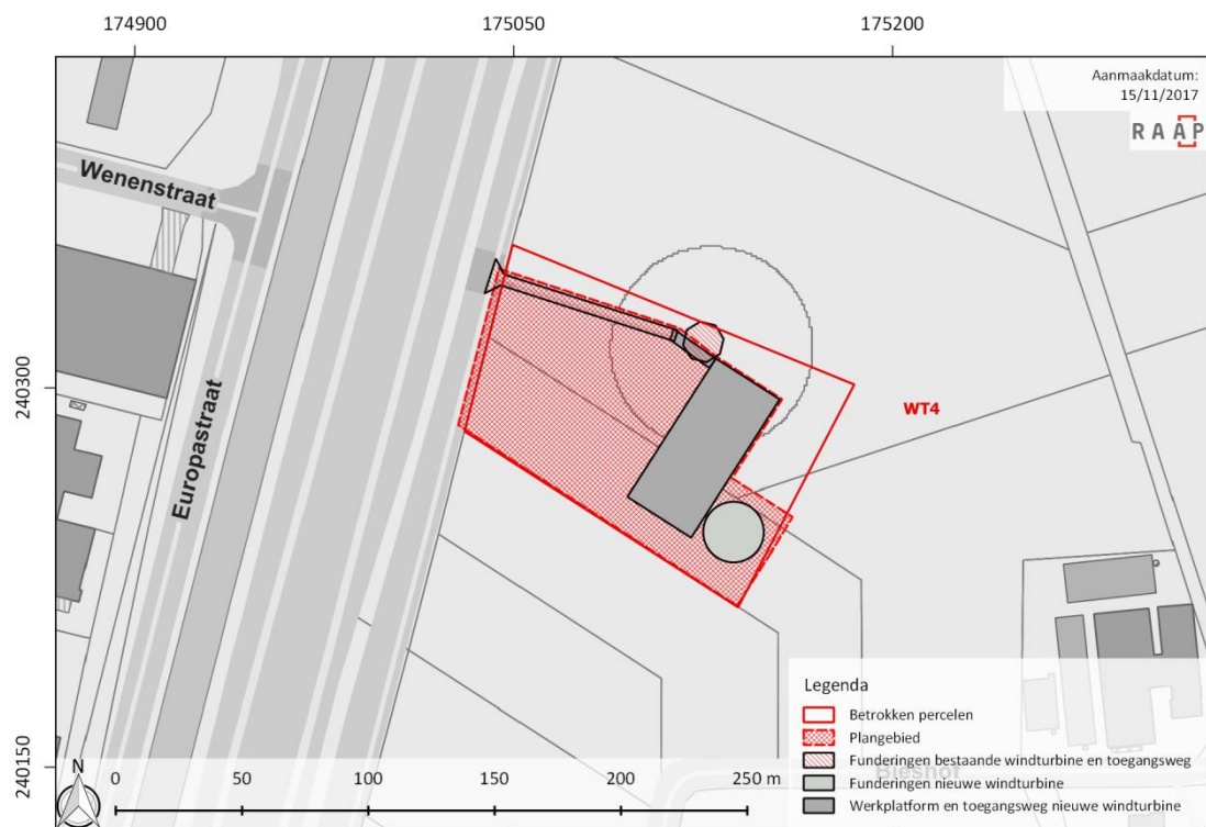
Figuur 14: Situering van WT4 met aanduiding van de bestaande windturbine (rood gearceerd) en de geplande ingreep (fundering van de windturbine (lichtgrijs) en de fundering voor het werkplatform en de toegangsweg (donkergrijs). (schaal 1/3000). (bron: AGIV, 2017b)
