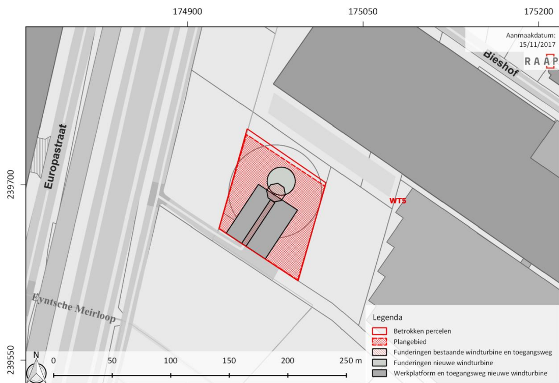
Figuur 15: Situering van WT5 met aanduiding van de bestaande windturbine (rood gearceerd) en de geplande ingreep (fundering van de windturbine (lichtgrijs) en de fundering voor het werkplatform en de toegangsweg (donkergrijs). (schaal 1/3000). (bron: AGIV, 2017b)
