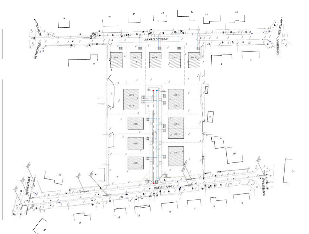
Afbeelding 1: Verkavelingsplan en rioleringsinfrastructuur (bron: Groep Infrabo Bureau voor Bouw en Infrastructuur).
