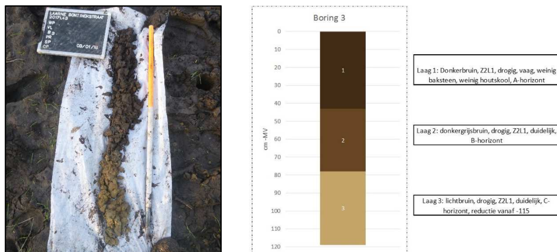
Figuur 41: Boring 3, foto en boorstaat (Bron: ABO nv)
