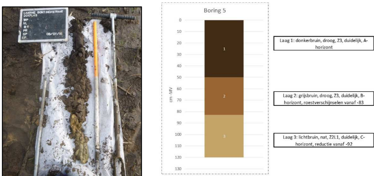
Figuur 43: Boring 5, foto en boorstaat (Bron: ABO nv)
