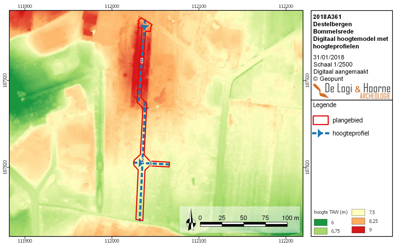
Figuur 11: Detail van het digitaal hoogtemodel met aanduiding van het projectgebied en de hoogteprofielen (© Geopunt)
