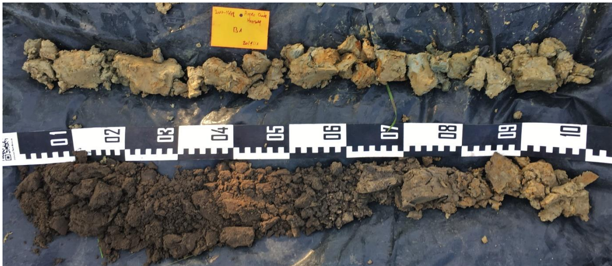
Figuur 7: Boring 1, van 0 (linksonder) naar 200 cm (rechtsboven) beneden maaiveld (foto door M. Creutz op 20-09-17).
