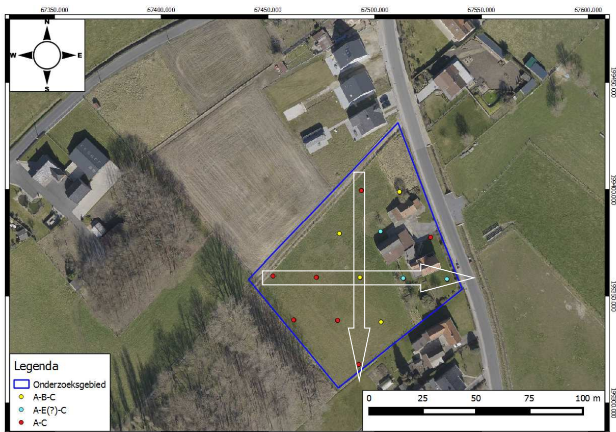
Figuur 41: Resultaten van het booronderzoek en transecten 1 (W-O) en 2 (N-Z) (bron: ABO nv 2017)
