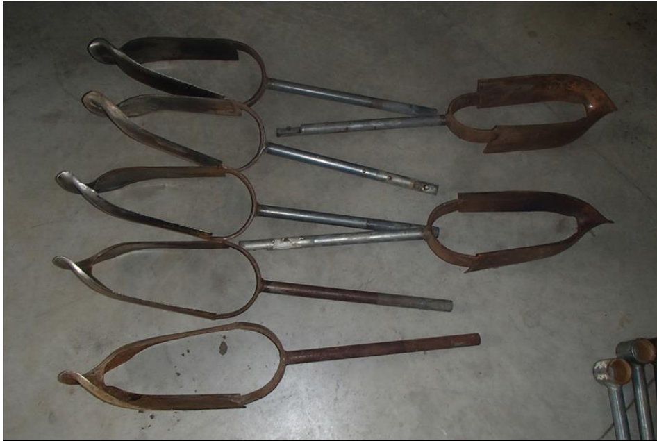
Figuur 4: Voorbeeld Edelmanboor – hier 15 cm diameter (©BAAC)
