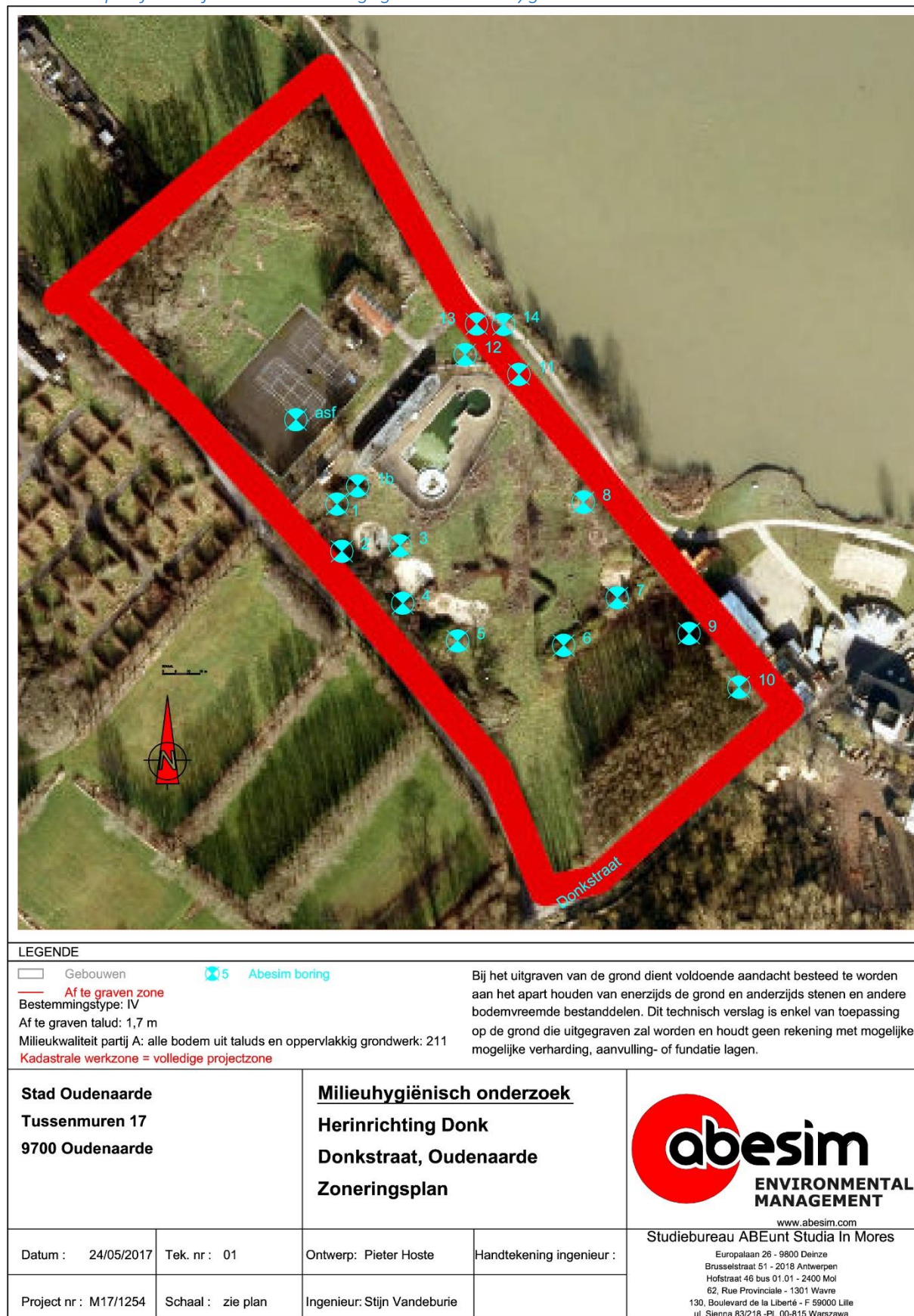
Figuur 31: Locatie uitgevoerde boringen in het kader van milieuhygiënisch onderzoek (digitaal aangemaakt, aanmaakschaal op plan, 24/05/2017, bron: abesim).
