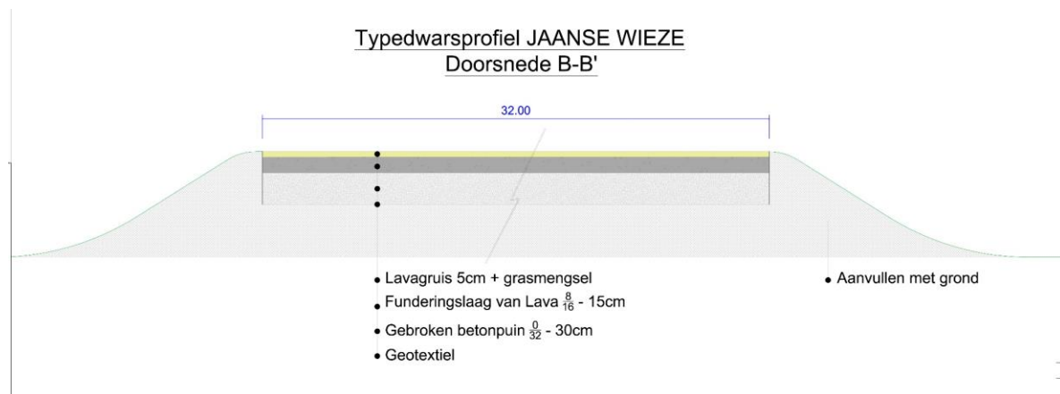
Figuur 9: Typedwarsprofiel 'Jaanse Wieze' (Stad Oudenaarde, aanmaakschaal 1/250, aanmaakwijze digitaal, 06/2017).
