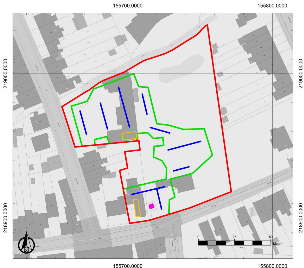
Figuur 3: Inplanting van de proefsleuven (blauw) binnen de te onderzoeken zone (groen), met aanduiding van de vermoedelijke ligging van kelders (oranje) en de aanwezige hoogspanningscabine (magenta)
