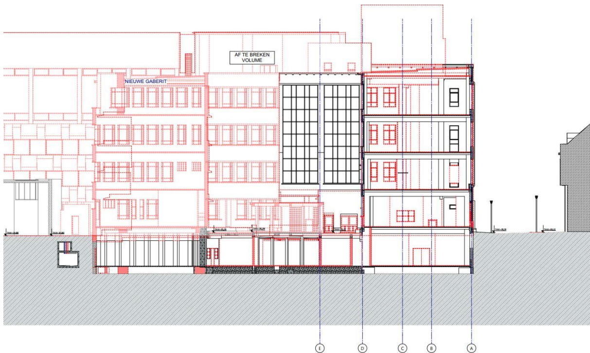
Figuur 12: Doorsnede van de bestaande (zwart) en geplande (blauw) inplanting. 19
