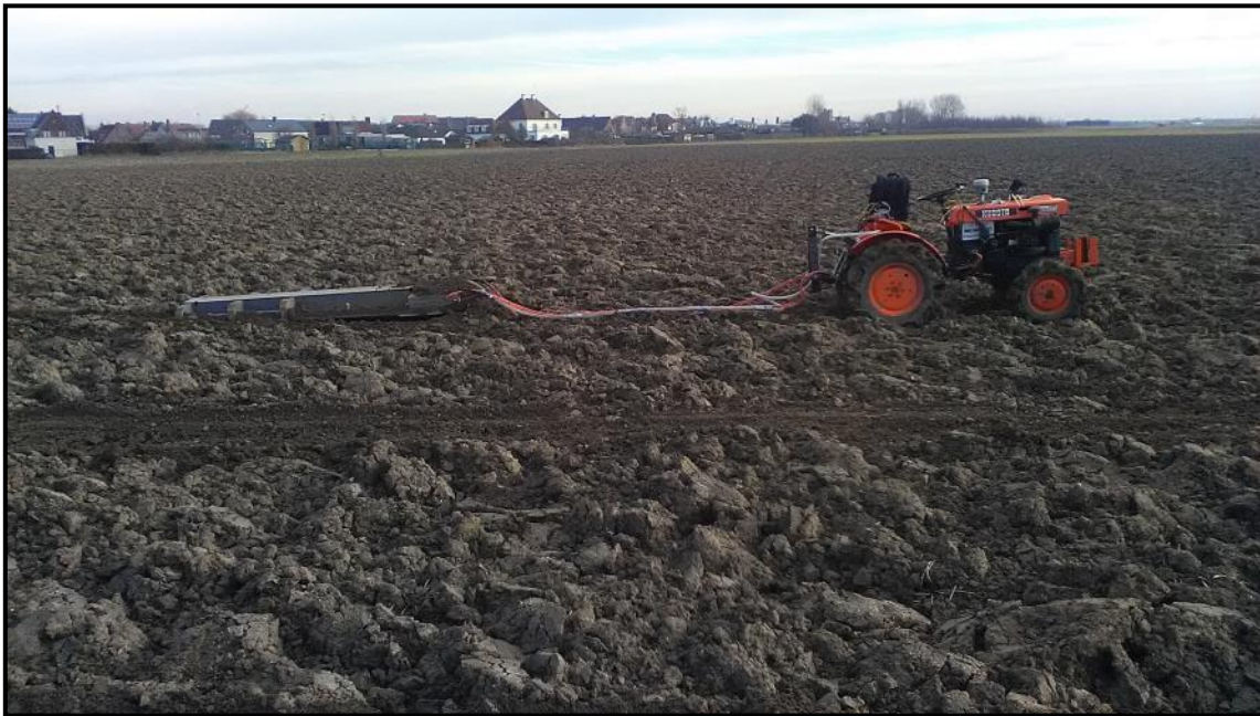
Figuur 28: Mobiele sensorconfiguratie met de EMI sensor in de slede en RTK-GPS.
