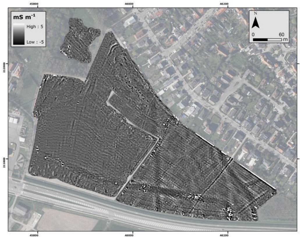
Figuur 38: 'High-pass' gefilterde EG opgemeten met de 2HCP spoelconfiguratie (dominante respons tussen 0 en 3.2 m diepte).
