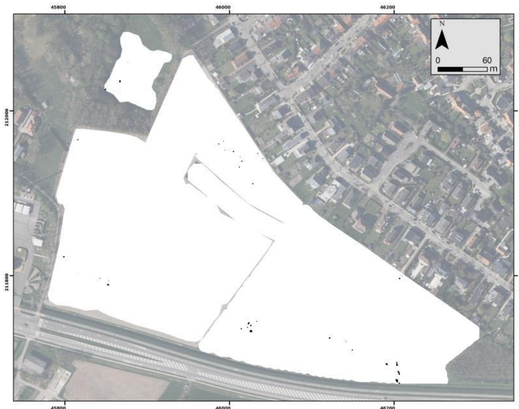
Figuur 41: Verstoringen veroorzaakt door begraven metaal op basis van de EG metingen.
