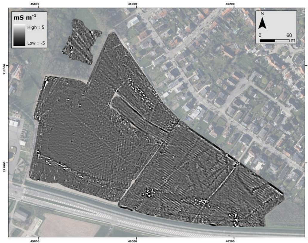
Figuur 31: 'High-pass' gefilterde EG opgemeten met de 1PRP spoelconfiguratie (dominante respons tussen 0 en 0.5 m diepte).
