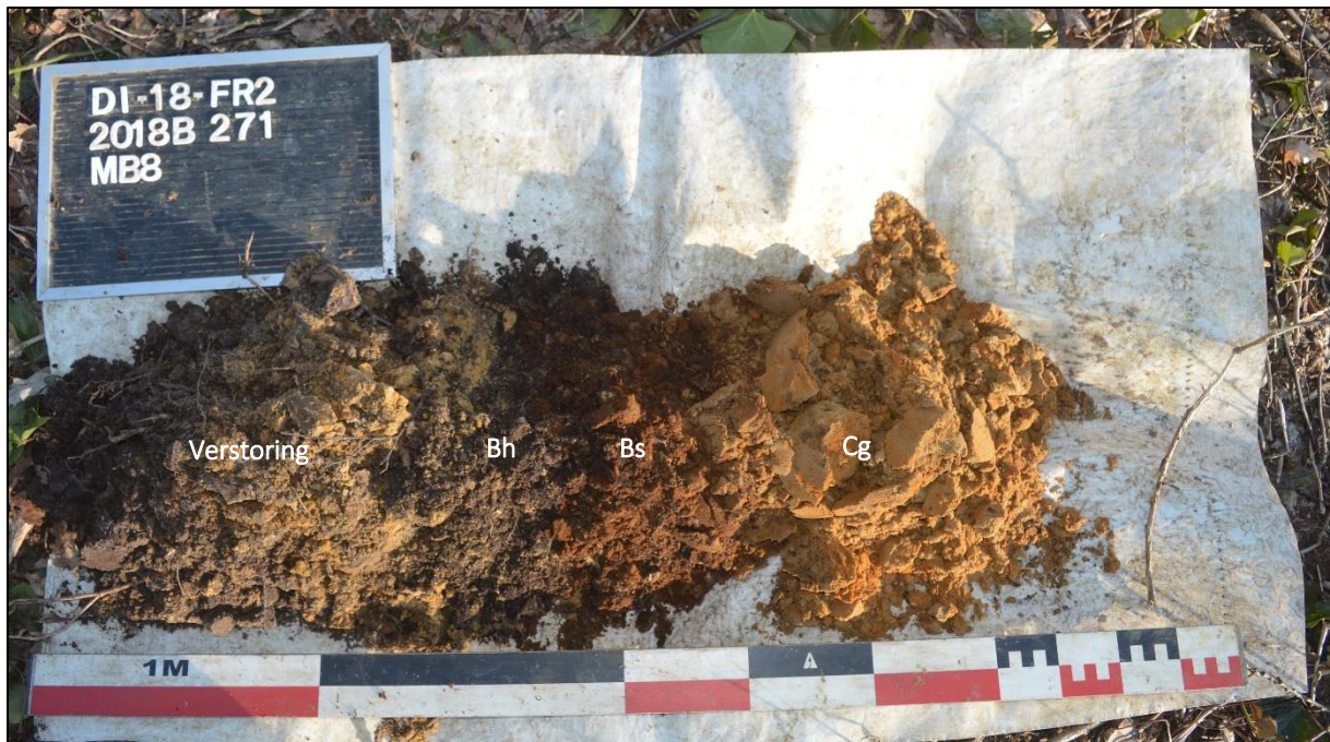
Afb. 17: Boorprofiel MB8 met boorprofiel Verstoring-Bh-Bs-Cg (Bron: Aron bvba, dd. 22/02/2018, 2018B271).
