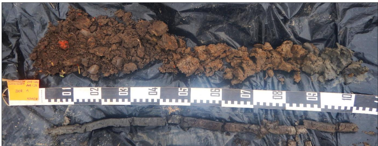
Foto 3: Boring 1 van 100 cm links boven tot 200 cm rechts beneden (©BAAC).
