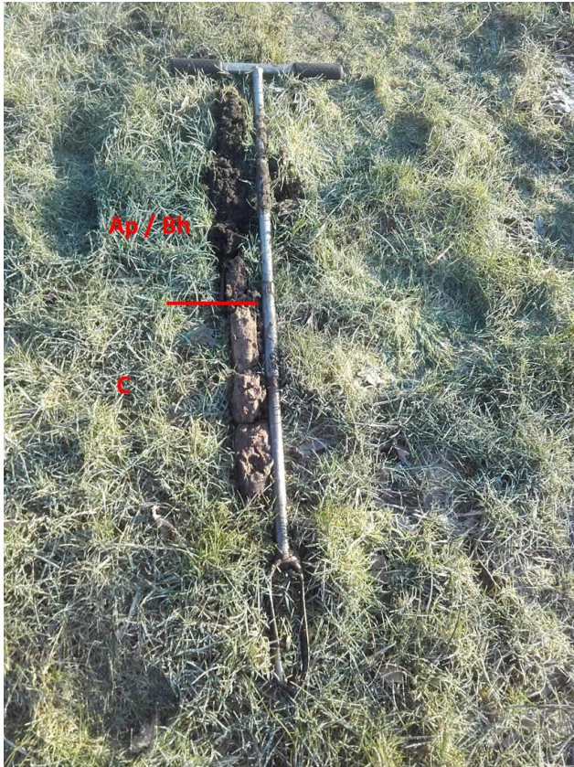
Figuur 11. Uitgelegd profiel van boring 7. De boor is 1.2 m lang.
