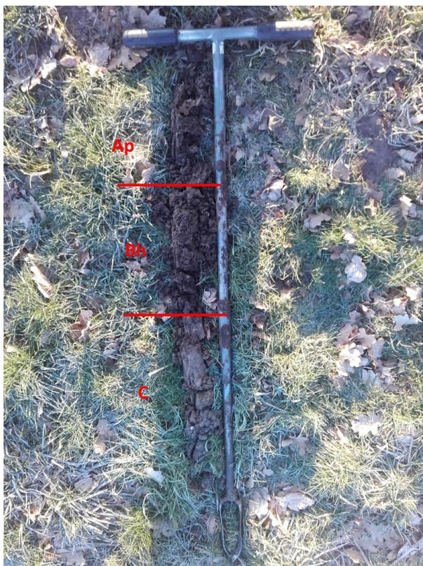
Figuur 10. Uitgelegd profiel van boring 3. De boor is 1.2 m lang.
