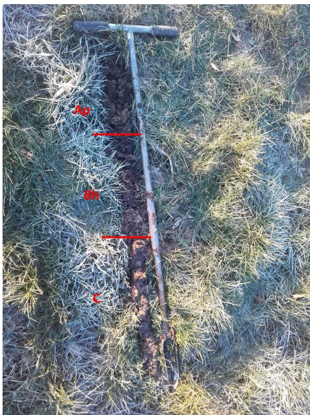
Figuur 9. Uitgelegd profiel van boring 2. De boor is 1.2 m lang.
