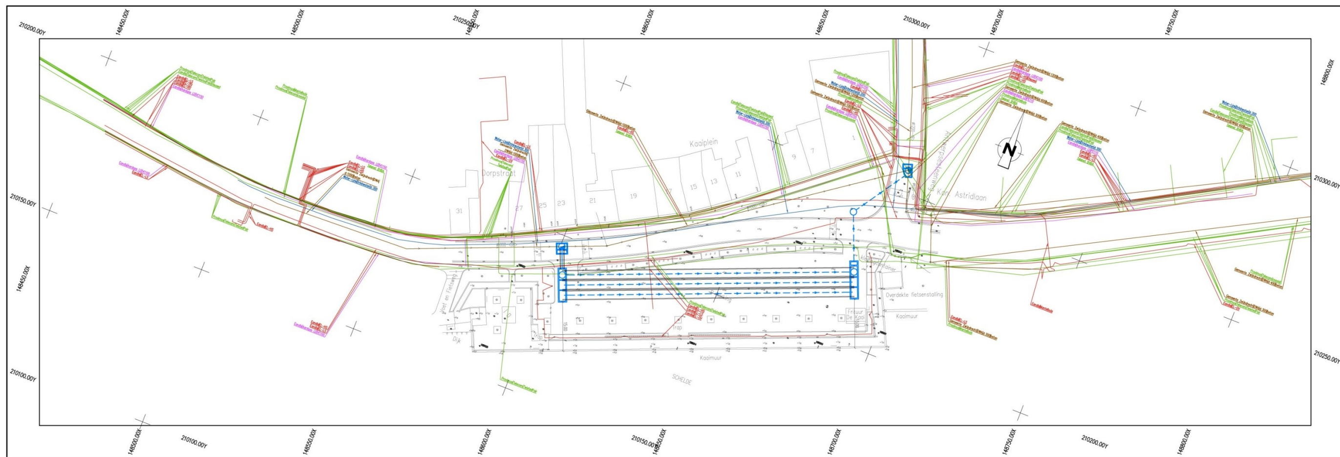
Figuur 7: Plan met aanduiding van de geplande werken (blauw) op het plan van de bestaande toestand met de reeds aanwezige nutsleidingen (Talboom group)
