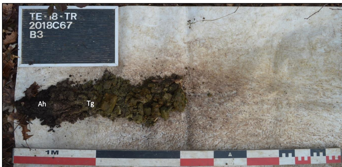
Afb. 42: Referentieprofiel B3 met boorprofiel Ah-Tg (Bron: Aron bvba, dd. 09/03/2018, 2018C67).
