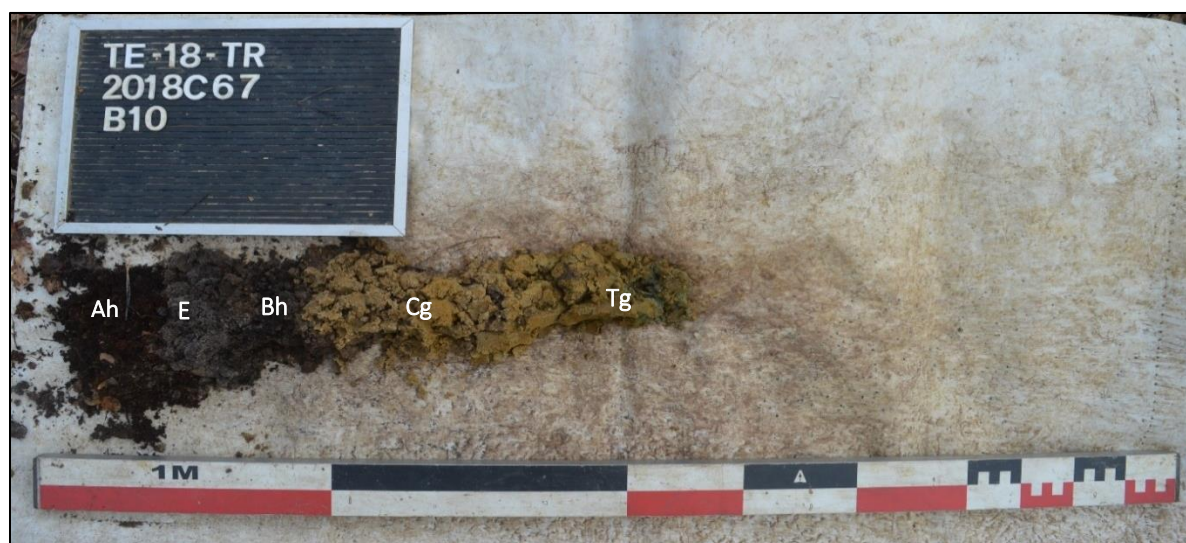
Afb. 35: Referentieprofiel B10 met boorprofiel A-E-Bh-Cn – Tg (Bron: Aron bvba, dd. 09/03/2018, 2018C67).
