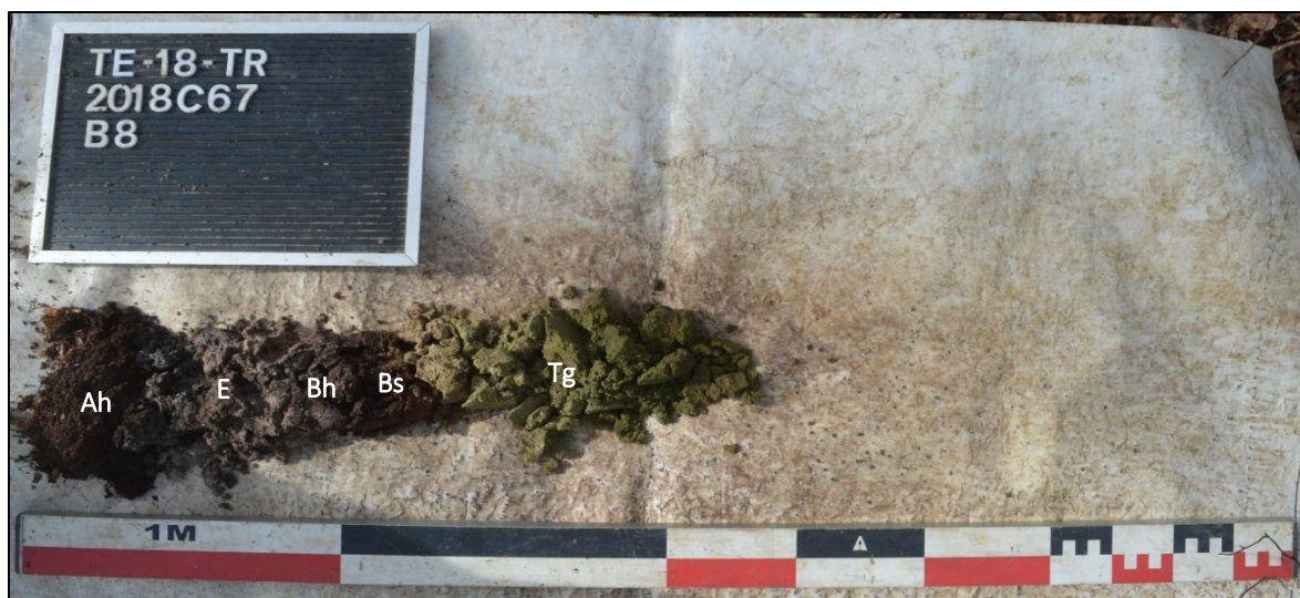
Afb. 30: Referentieprofiel B8 met boorprofiel A-E-Bh-Bs- Tg (Bron: Aron bvba, dd. 09/03/2018, 2018C67).
