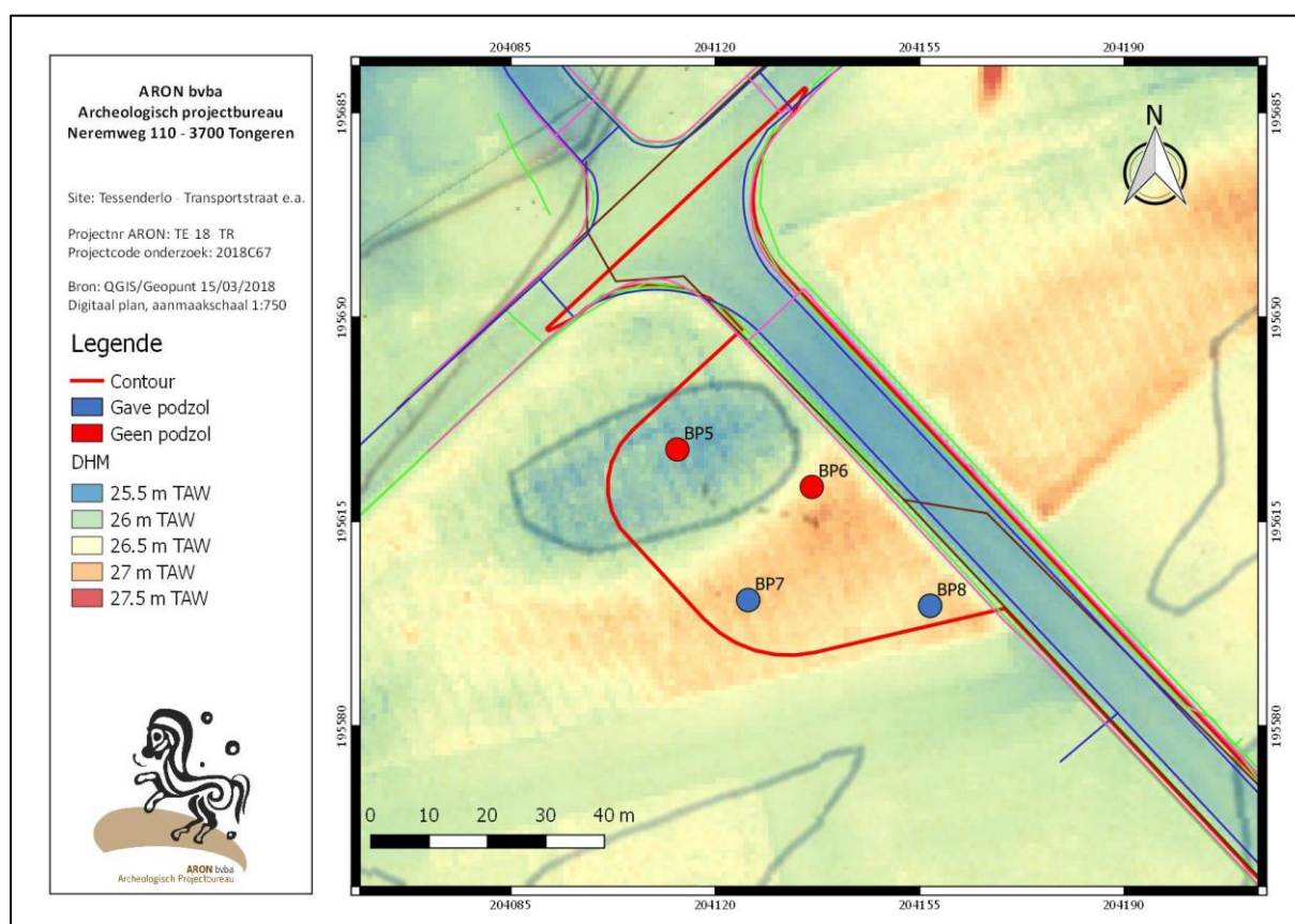
Afb. 33: Boorresultaten deelgebied 1.1 geprojecteerd op het Digitaal Hoogtemodel en de Atlas der Buurtwegen. De nutsleidingen zijn aangeduid in het paars (gas), groen (telecommunicatie), bruin (riolering) en blauw (waterleiding).
