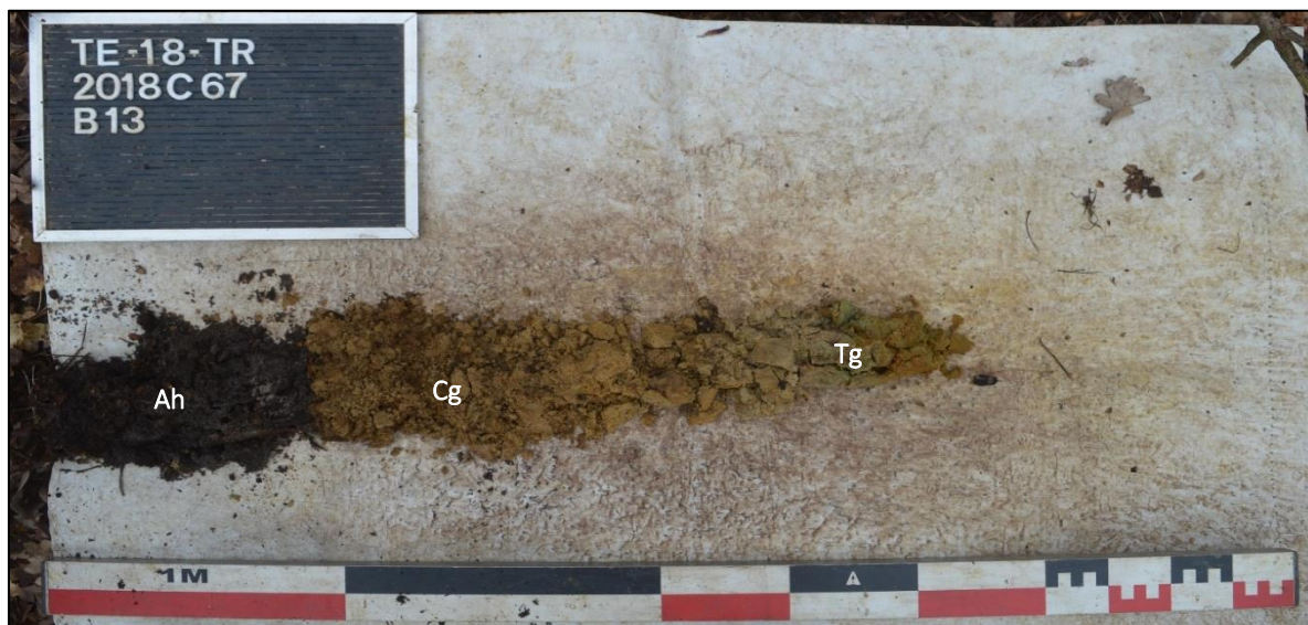
Afb. 37: Referentieprofiel B13 met boorprofiel Ah-Cg-Tg (Bron: Aron bvba, dd. 09/03/2018, 2018C67).
