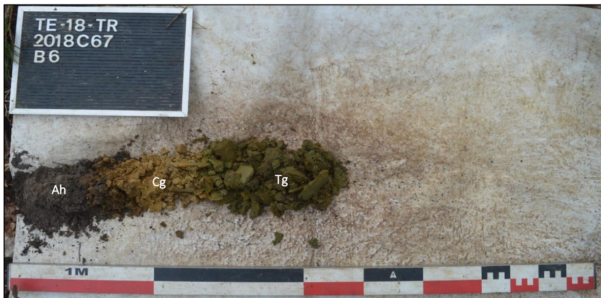
Afb. 31: Referentieprofiel B6 met horizonten Ah – Cg – Tg (Bron: Aron bvba, dd. 09/03/2018, 2018C67).
