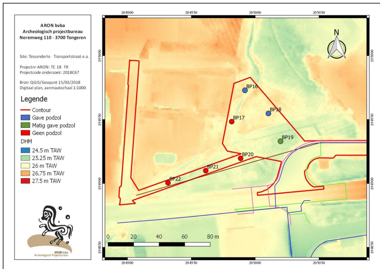
Afb. 49: Boorpunten met aanduiding van de bewaring van de podzol geprojecteerd op het Digitaal Hoogtemodel. De ondergrondse nutsleidingen zijn aangeduid in het paars (gas), groen (telecommunicatie), bruin (riolering) en blauw (waterleiding).
