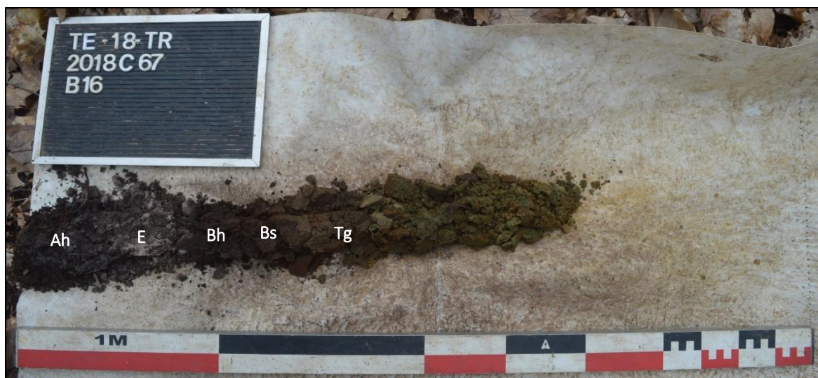
Afb. 46: Referentieprofiel B16 met boorprofiel A-E-Bh-Bs-Tg (Bron: Aron bvba, dd. 09/03/2018, 2018C67).
