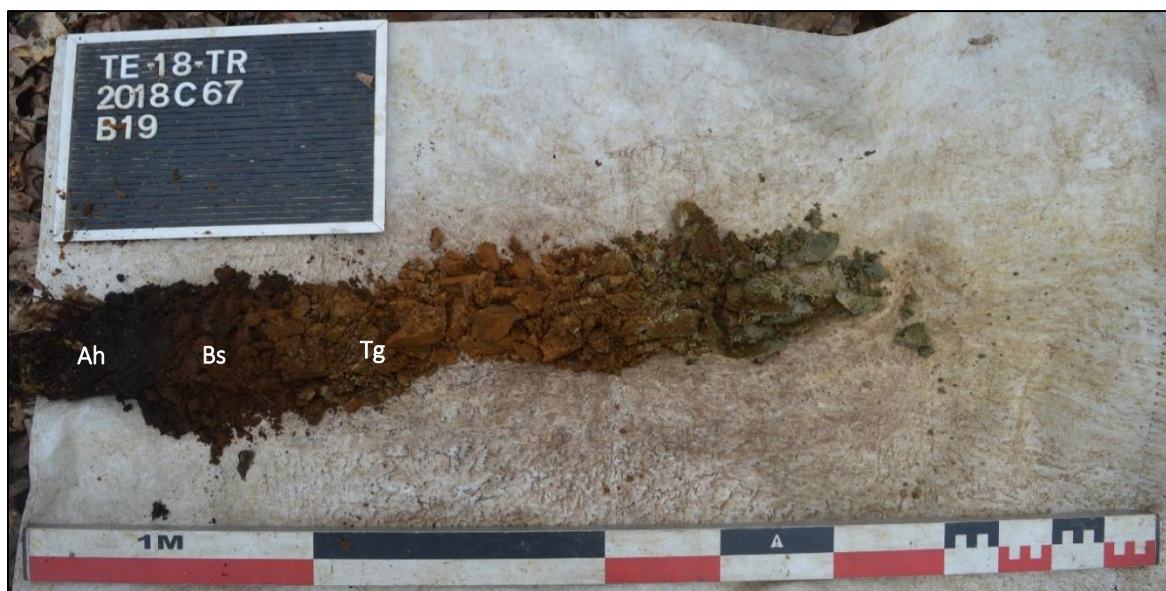
Afb. 47: Referentieprofiel B19 met boorprofiel A-Bs-Tg (Bron: Aron bvba, dd. 09/03/2018, 2018C67).
