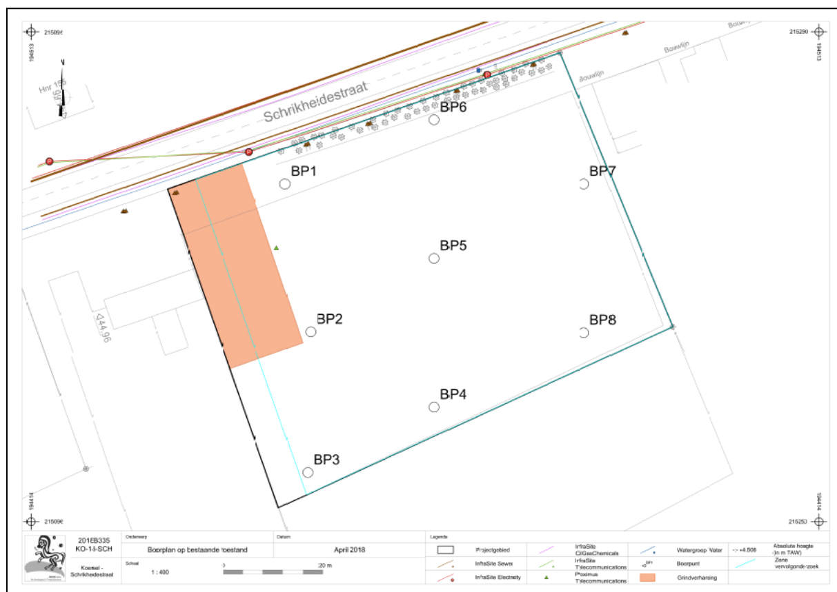
Afb. 28: Boorplan op bestaande toestand (BT) met aanduiding van de boorpunten, de grindparking (bruin), het onderzoeksterrein (blauw) en het volledige projectgebied (zwart) (Bron: ARON bvba, digitaal plan, dd 06/03/2018 aanmaakschaal 1.400, 2018B335).
