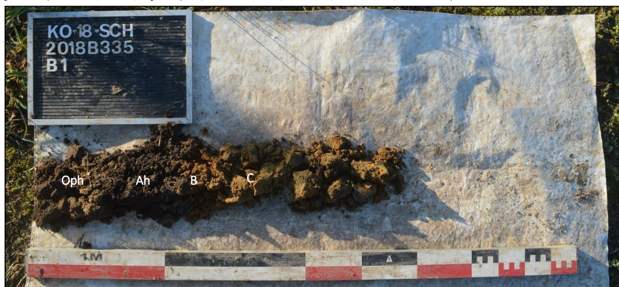
Afb. 33: Referentieprofiel BP 1 met bodemhorizonten Ophoging – Ah – B – C (Bron: ARON bvba, dd 06/04/2018, 2018B335).
