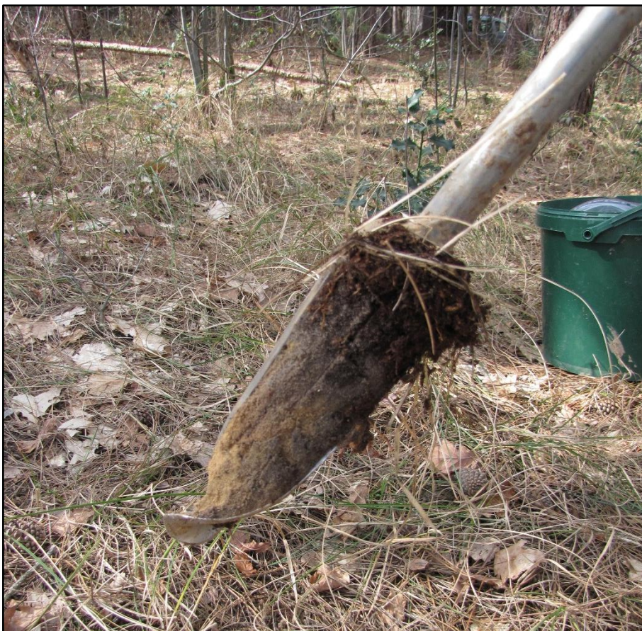
Figuur 20 Detail van het bovenste bodempakket in de boorkop met de overgang tussen de stroisellaag, het fijne humeuze laagje en de zandlaag.
