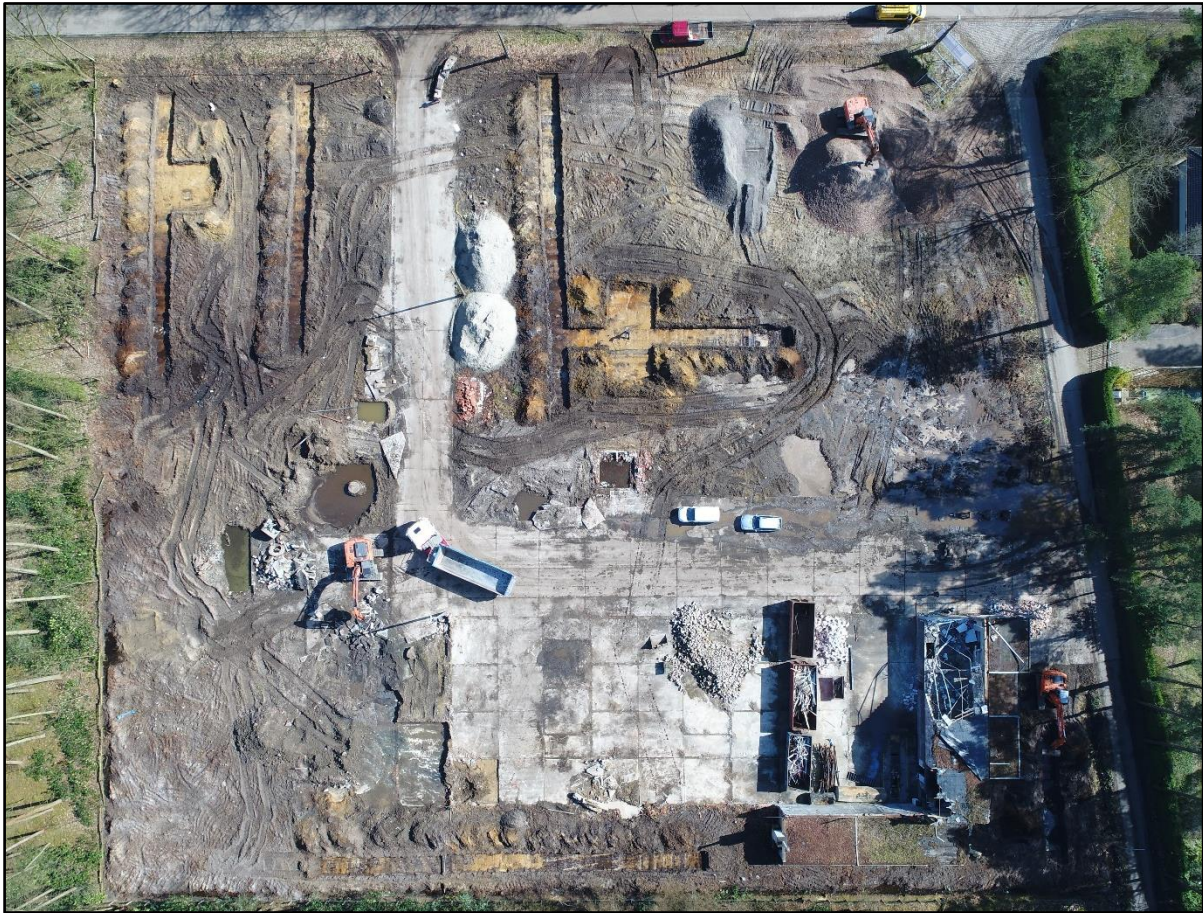
Figuur 9 Dronefoto van de toestand na aanleg van de proefsleuven in de niet verstoorde zones. Merk duidelijk het vierkanten patroon van 3 x 3m bij het magazijn/tankstation en verhardingen.
