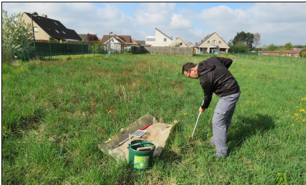
Figuur 26 Manueel uitvoeren van de grondboringen.
