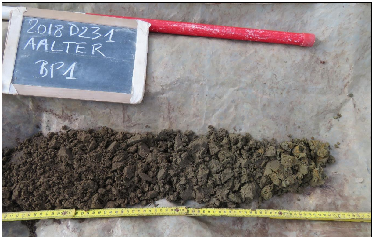
Figuur 29 Overgang van de zandige C-horizont naar een kleiige C-horizont op een diepte van ca. 95cm.
