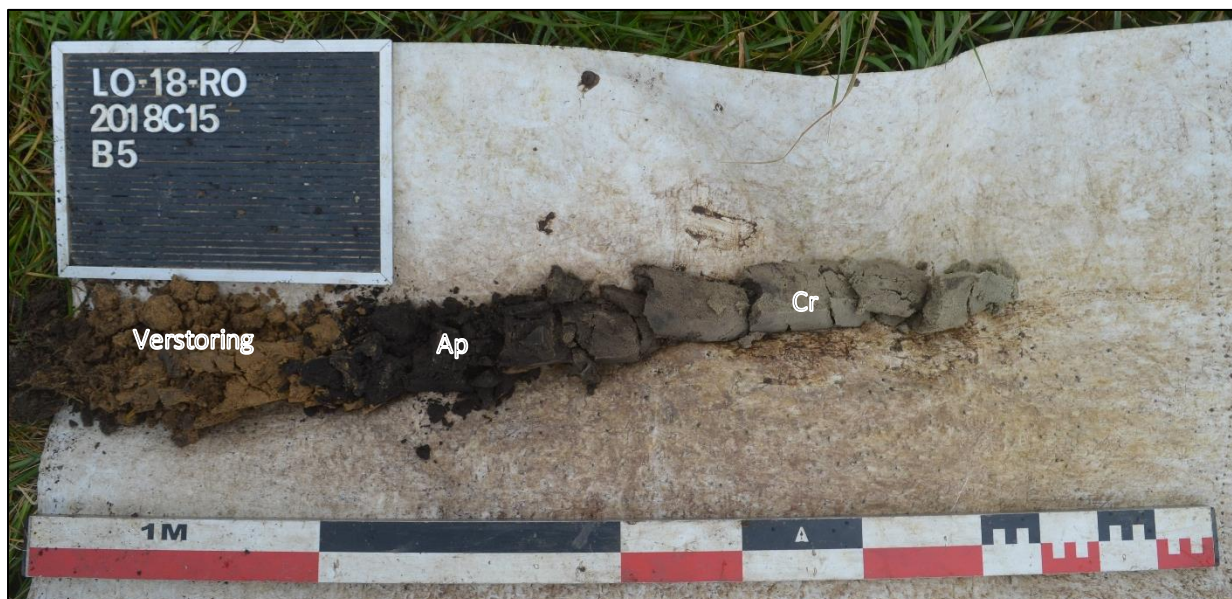
Afb. 42: Referentieprofiel BP5 met bodemhorizonten Verstoring-Ap-C (Bron: ARON bvba, dd. 23/03/2018, 2018C15).
