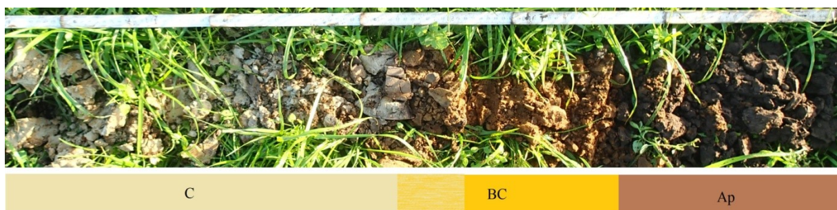
Fig. 3. Foto en schematische voorstelling van typeprofiel 3.
