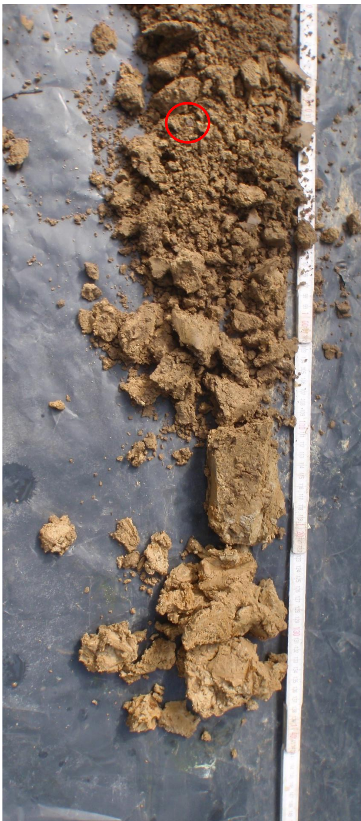
Foto 6: Close-up controleboring 3 met aanduiding van het betonpuin (© J. Verrijckt Bvba)
