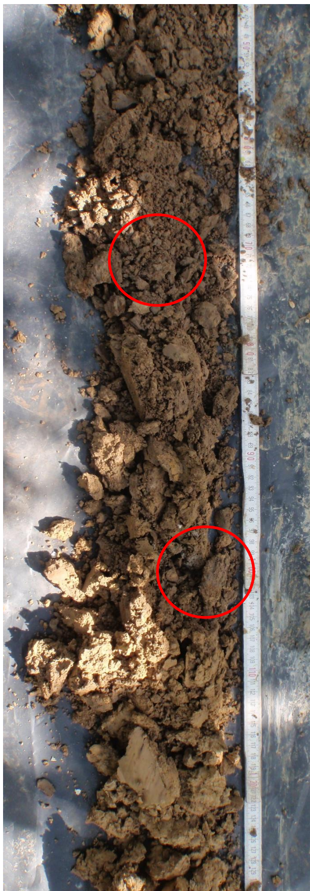
Foto 14: Close-up controleboring 5 met aanduiding van het betonpuin (© J. Verrijckt Bvba)
