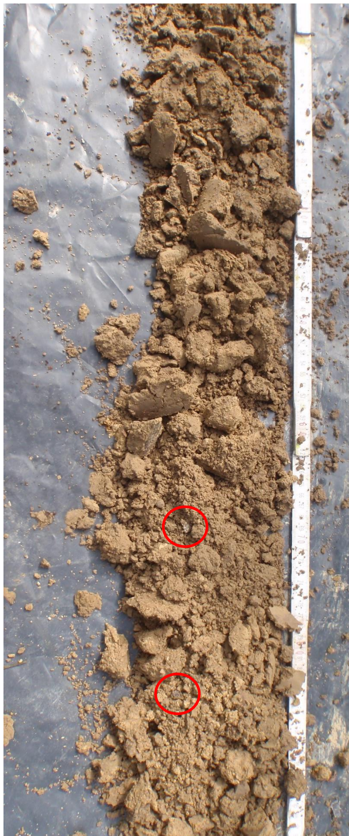
Foto 5: Close-up controleboring 3 met aanduiding van het betonpuin (© J. Verrijckt Bvba)
