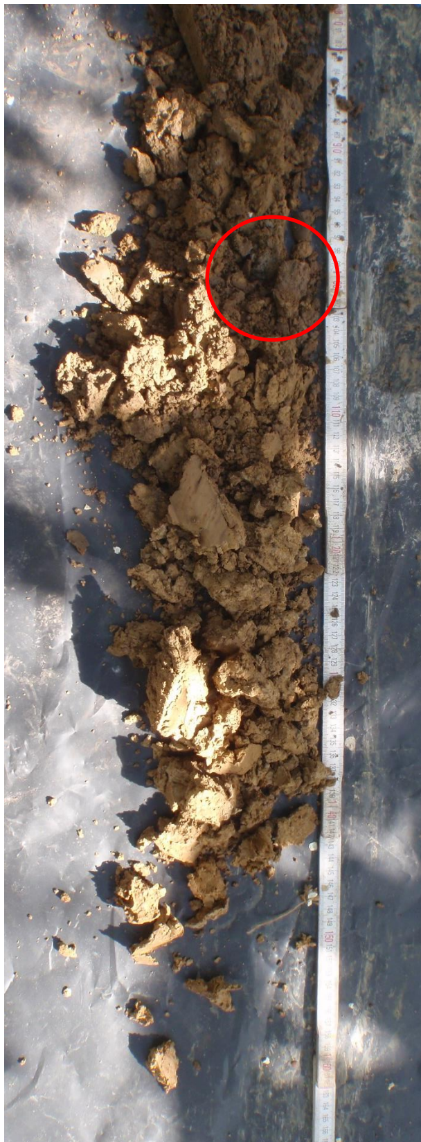
Foto 15: Close-up controleboring 5 met aanduiding van het betonpuin (© J. Verrijckt Bvba)
