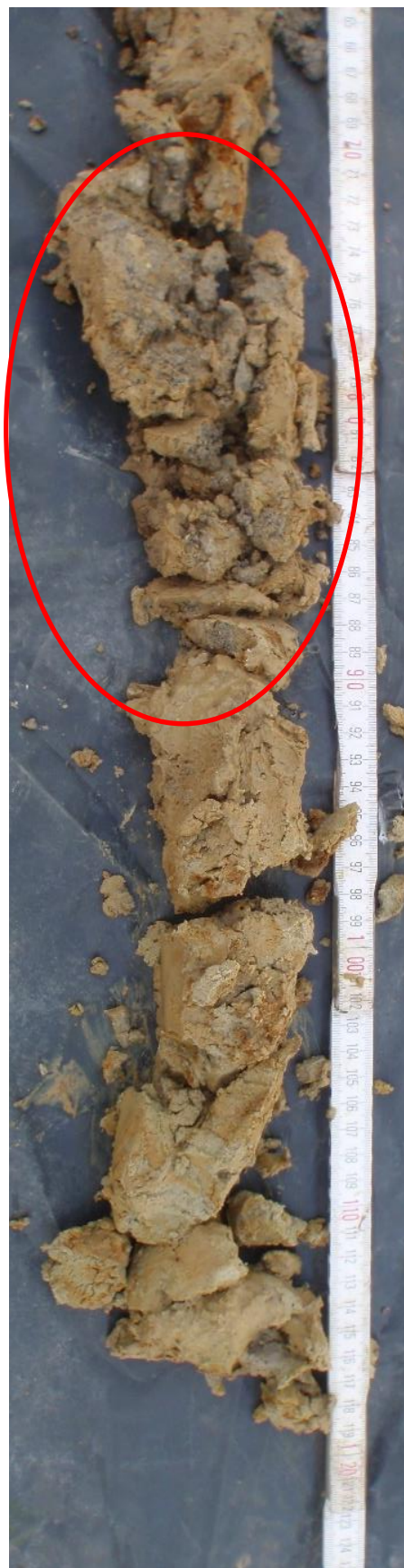
Foto 10: Close-up controleboring 4 met aanduiding van het betonpuin (© J. Verrijckt Bvba)
