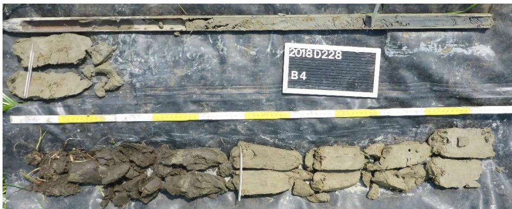
Figuur 34: Profiel boring B4
