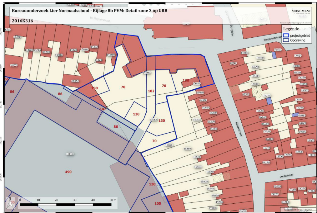
Afb. 12. Basiskaart Vlaanderen (GRB) ter hoogte van zone 3a met daarop in rood de opgravingsdieptes (diepte van de geplande werken + 30 cm buffer).
