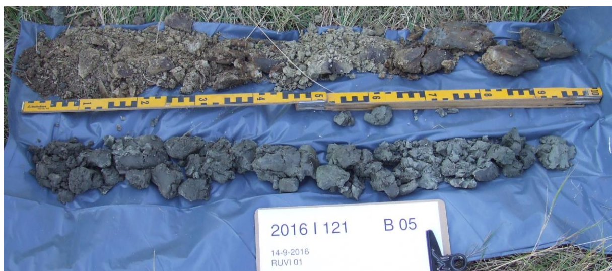
figuur 27 Boring 5. De leesrichting van de boring is van boven naar onder en dan steeds van links naar rechts. (Foto: R. Paulussen, 14 september 2016.)
