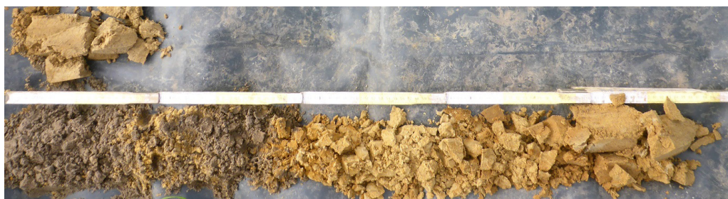
Figuur 44: Boring B21 met eolisch afgezet dekzand uit het weichseliaan op geringe diepte (© GATE)
