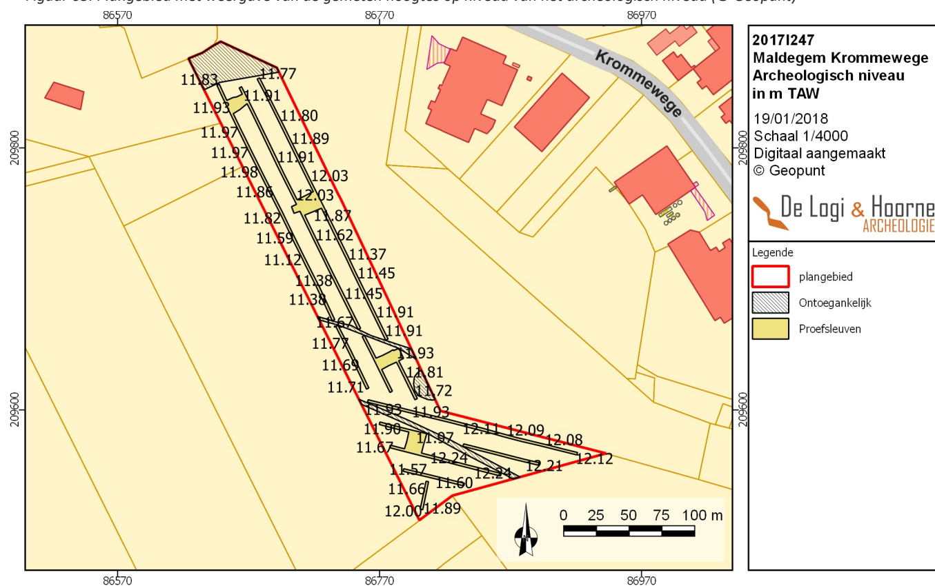
Figuur 63: Plangebied met weergave van de gemeten hoogtes op niveau van het archeologisch niveau (© Geopunt)
