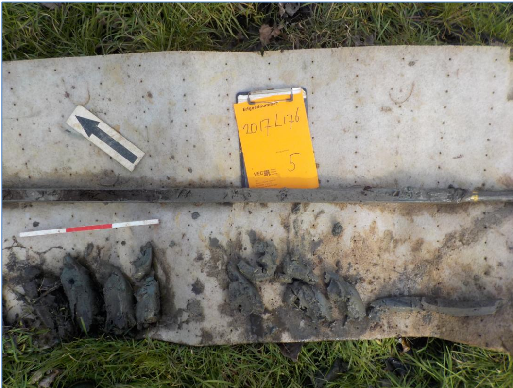
Afb. 10. Boring 5 (uitgelegd van onderen naar boven: 0-50cm, 50 –100cm, 100-200cm guts).
