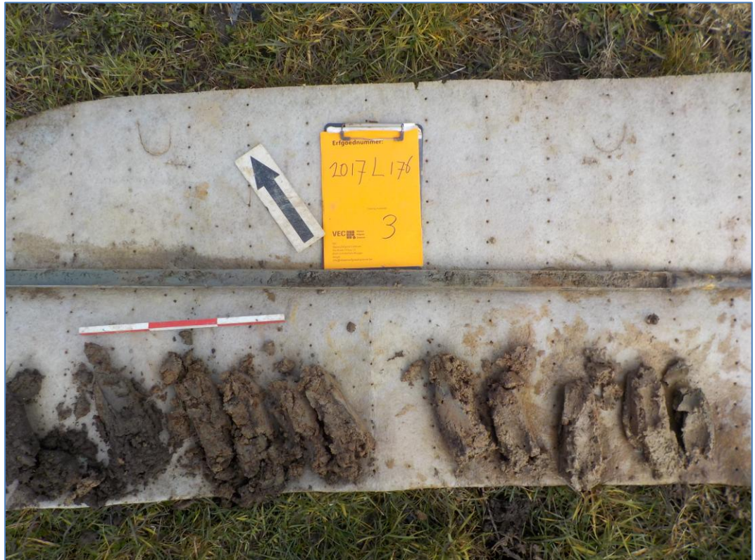
Afb. 12. Boring 3 (van links naar rechts uitgelegd: 0-50 cm, 50 –100cm, 100-200 cm –mv, guts ).
