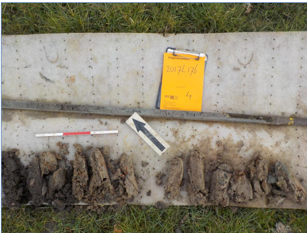
Afb. 11. Boring 4 (uitgelegd van onderen naar boven: 0-50cm, 50 – 100cm, 100-200cm guts).
