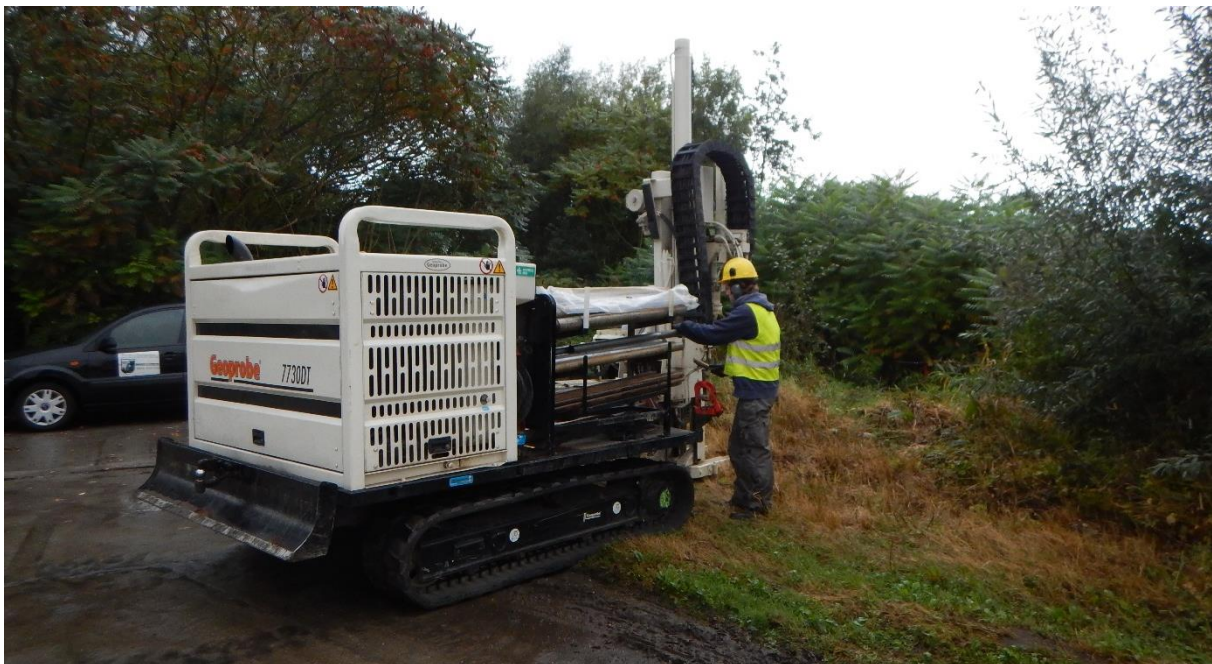
Figuur 16: Foto van boormachine Geoprobe 7730 DT (Foto P. Pawelczak, 30-09-2016)
