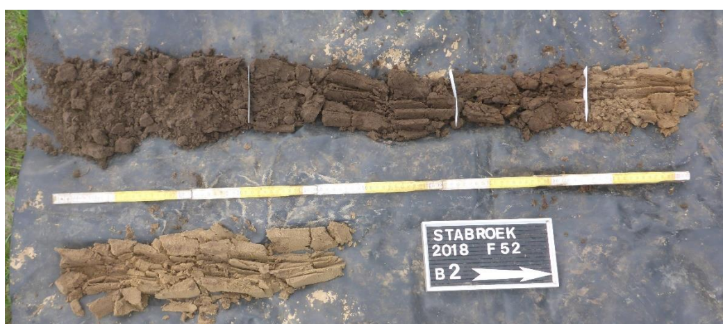
Figuur 21. Boring 2 met een sequentie van eolisch zand, gevolgd door fluviatiel klei en estuarien zand.
