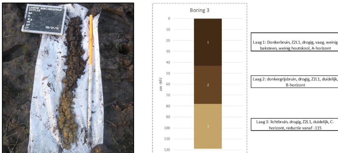
Figuur 38: Boring 3, foto en boorstaat (Bron: ABO nv)
