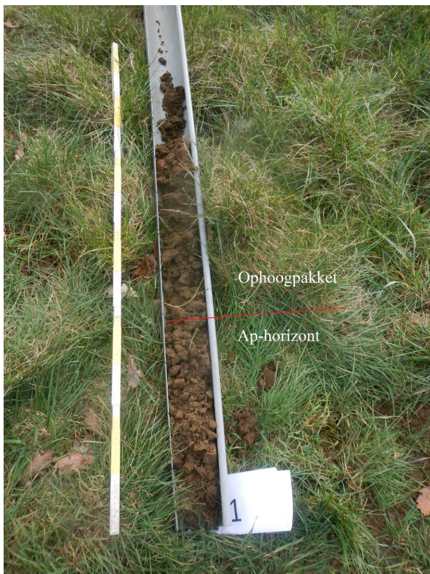
Afbeelding 5: Boring 1 met een ophoogpakket onder de Ap-horizont.
