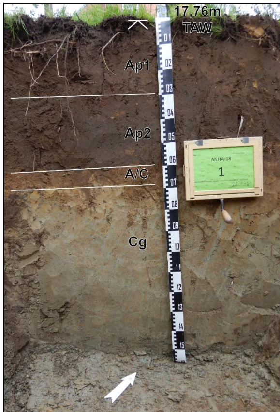
Figuur 43: Profiel 1 met aanduiding van de verschillende bodemhorizonten.
