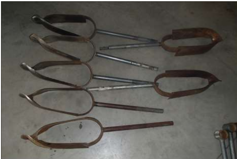
Figuur 2: Voorbeeld Edelmanboor met diameter van 15 cm (©BAAC)
