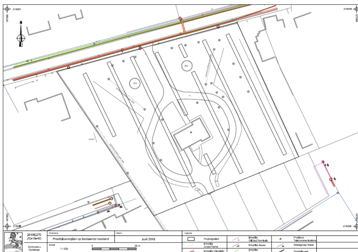
Afb. 47: Sleuvenplan op de bestaande toestand (BT). (Aron bvba, dd. 01/06/2018, digitaal plan, aanmaakschaal 1.500, 2018E214 & 2018E270).
