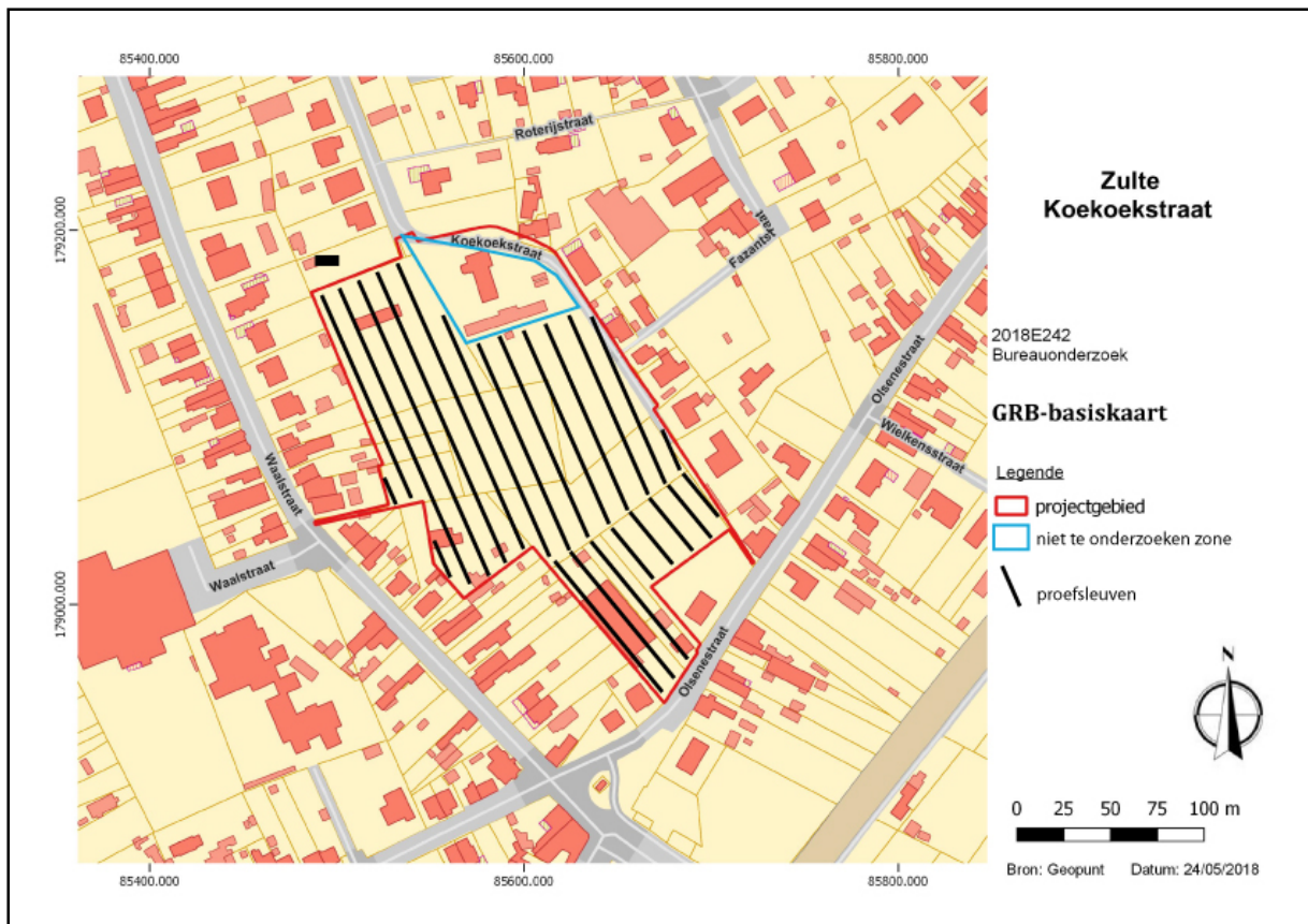
Figuur 3 Voorstel proefsleuven geprojecteerd op het kadasterplan (bron: geopunt).
