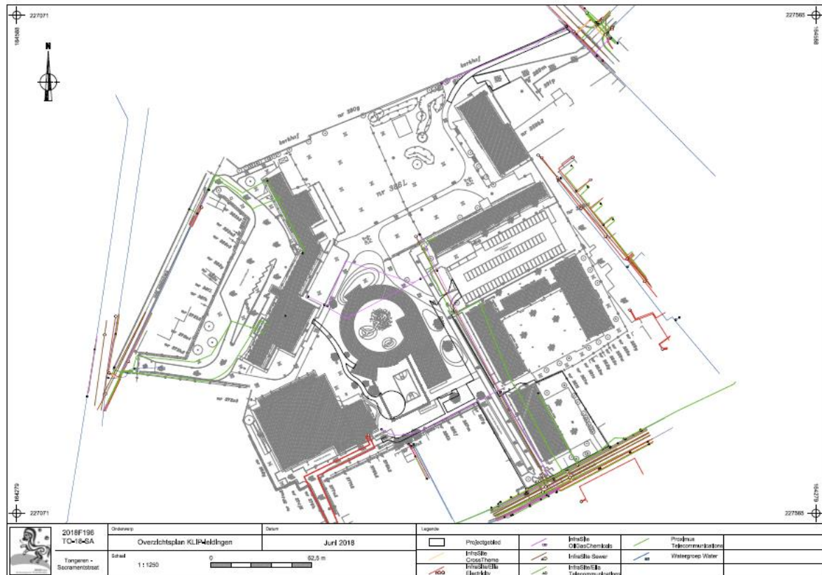
Afb. 40: Overzicht aanwezige nutsleidingen op het onderzoeksterrein (Bron: KLIP, digitaal plan, dd 25/06/2018, aanmaakschaal 1.1250, 2018F196).
